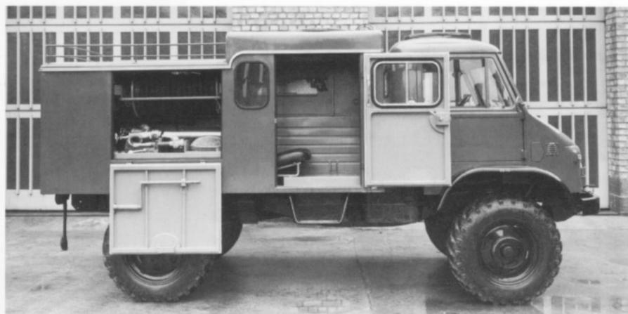
Der Unimog S als Vorserienfahrzeug mit baugleichem Aufbau von Metz und Bereifung 10.00-20. Gut ist auf diesen Bildern ein Teil der Beladung zu erkennen. (s. auch S. 39)
