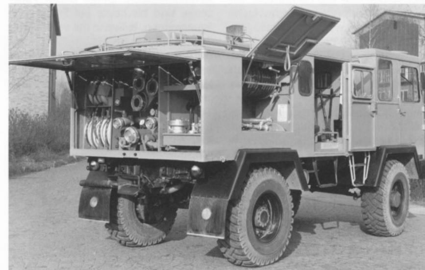
**Einblick gewährt: Die rechte Fahrzeugseite des Büssing-Prototypen mit feuerwehrentechnischer Beladung. Die Aufbauten waren bei allen Fahrzeugen identisch.**
