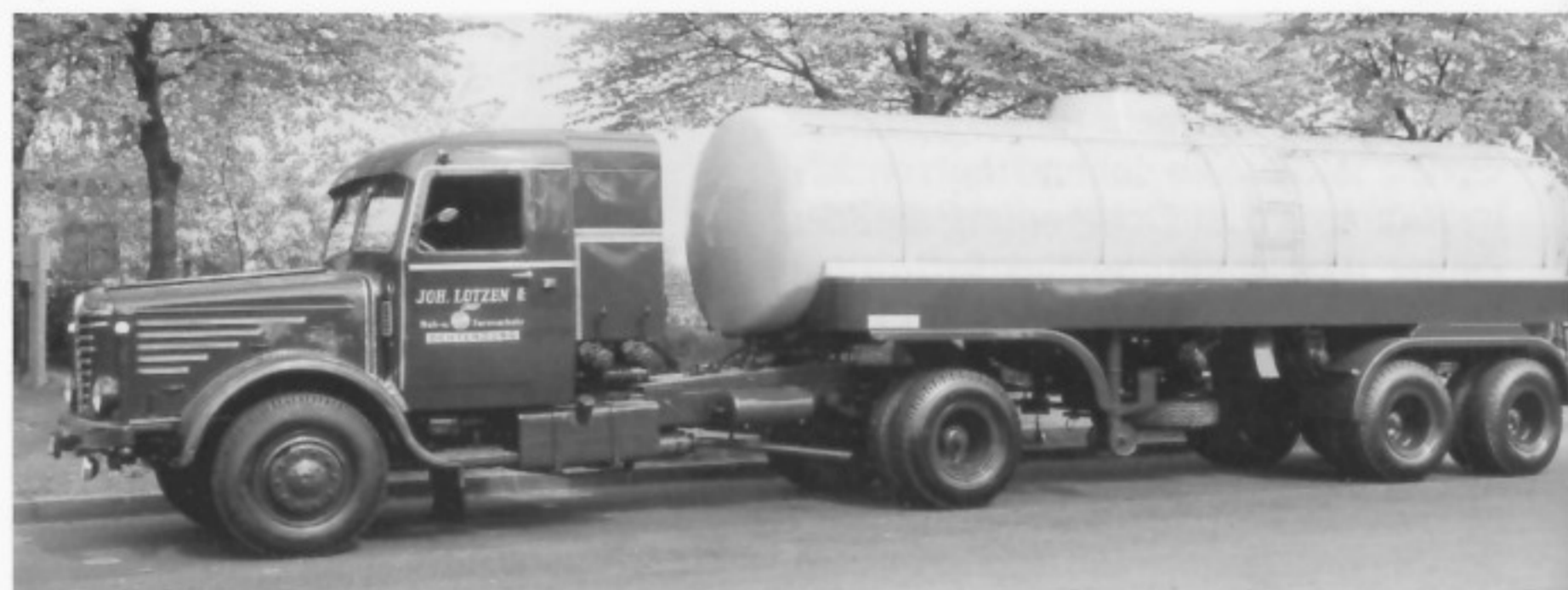
Mit Schwalbennest: Büssing 7500 S mit Bauer-Tankaufleger.
