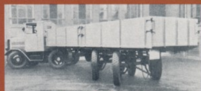
Zwangsgelenkter Fuchs-Auflieger mit Zugmaschine F.M.6/10.
