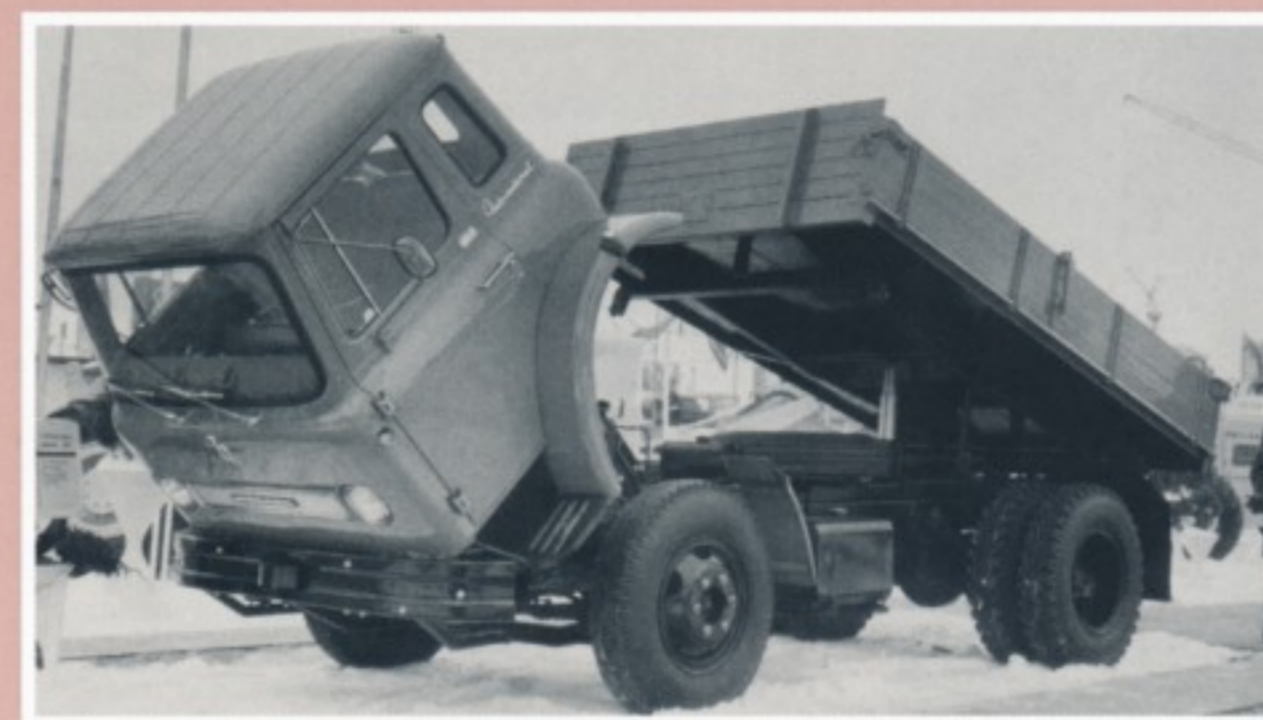
▲ 4-Seiten-Kipper: Die Kippkabine gewährleistete optimalen Zugang zum Motor.
