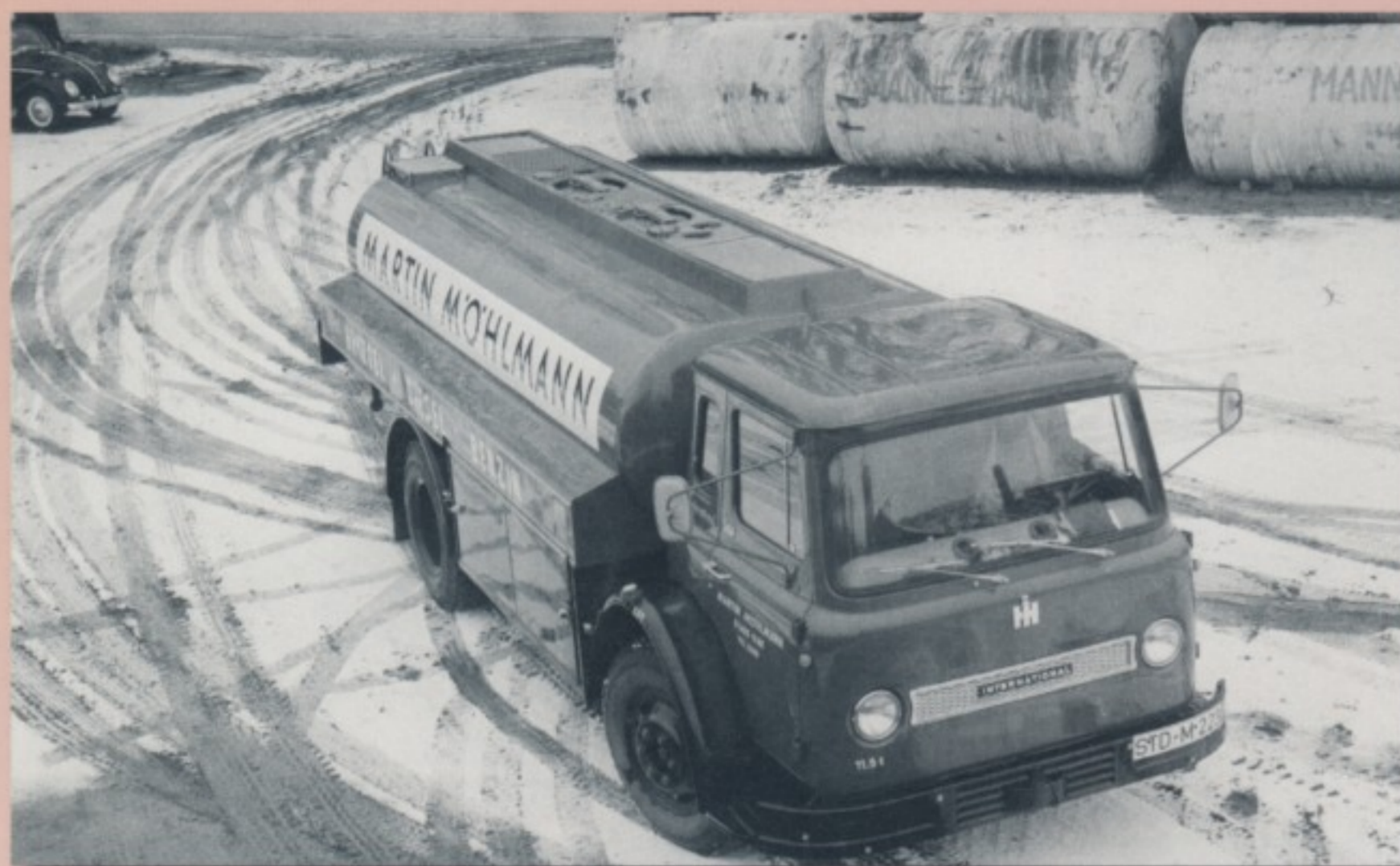
▲ Als Fahrgestell für Sonderfahrzeuge wie etwa Tankwagen bot IH den CO 1700 H mit 11,5 Tonnen Gesamtgewicht an.
