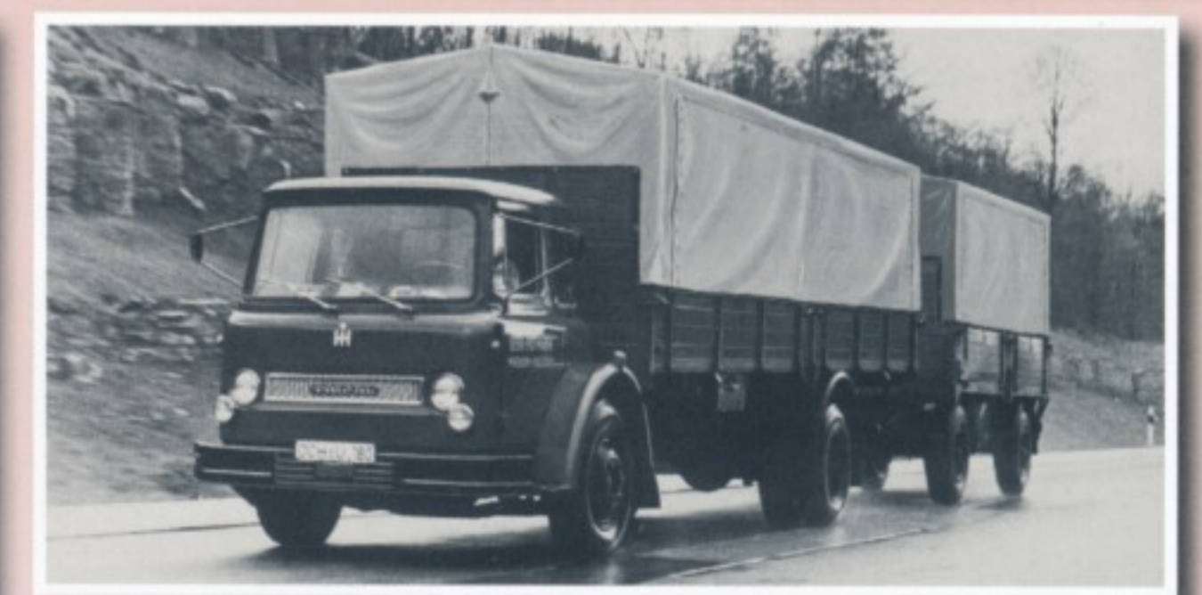
Allein auf weiter Flur: Die deutsche Nutzfahrzeugindustrie konnte dem in insgesamt sechs verschiedenen Radständen erhältlichen CO 1700 nichts Gleichwertiges entgegensetzen.
