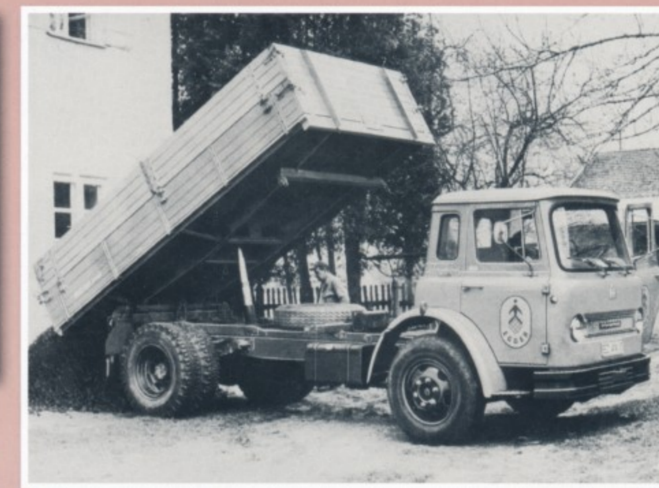
▲ 4-Seiten-Kipper: Die Kippkabine gewährleistete optimalen Zugang zum Motor.
