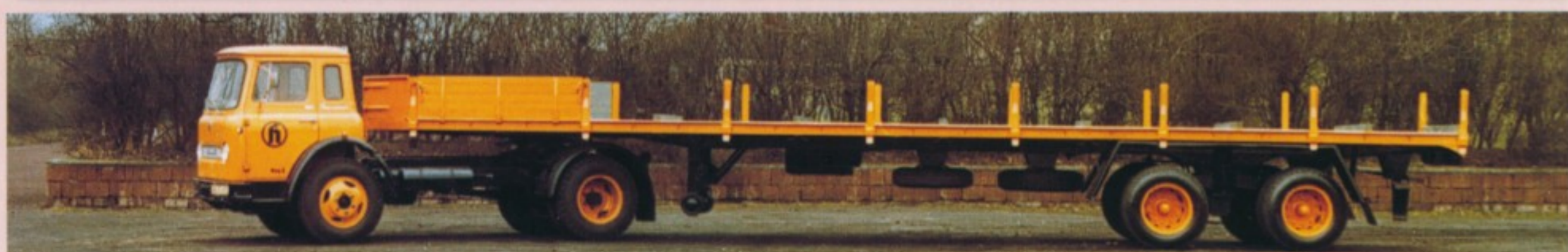
Mehr als 11 Tonnen Langeisen durfte man diesem Loadstar CO 1700 S mit Bunge-Auflieger zumuten – dann allerdings kamen die 125 Pferde gehörig ins Schwitzen.
