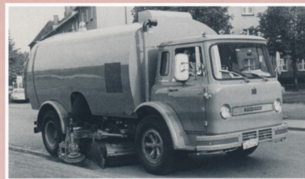
Loadstar CO 1700 H, der von Schörling mit einer selbstaufnehmenden Kehrmaschine ausgerüstet wurde.
