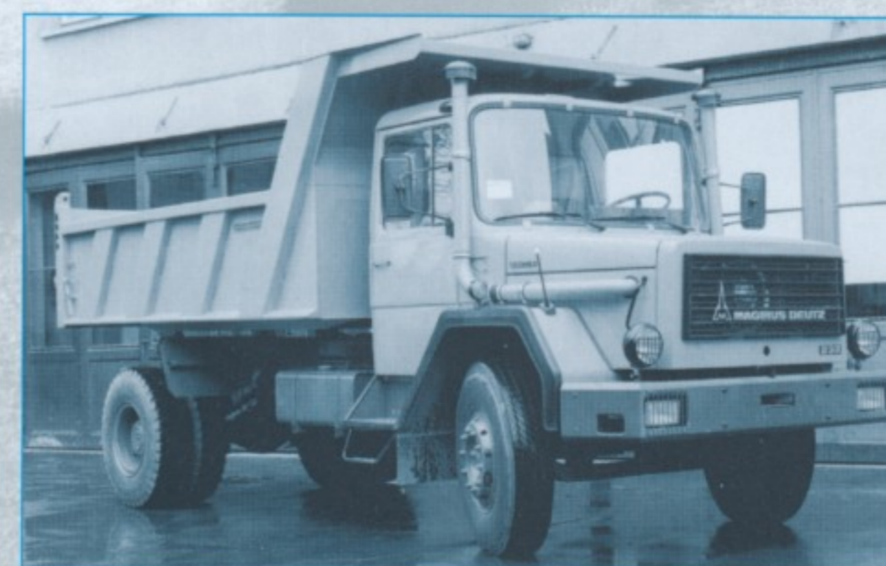
Für den Tunnelbau: Der zweiachsige M 232 D 19 K 4x2 gehörte sowohl mit beheizbarer Flachmulde als auch mit Gesteinsmulde ohne Heckklappe zum Lieferumfang.
