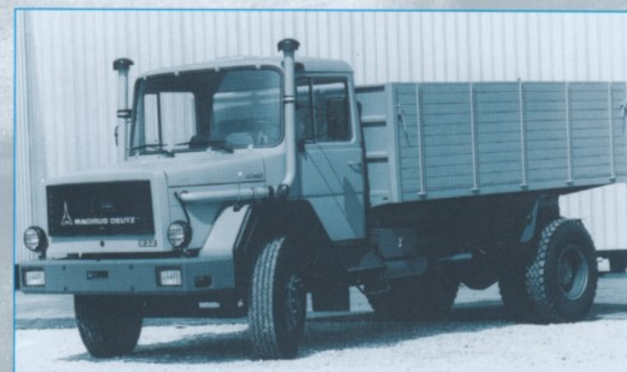
Kögel in Ulm lieferte hochbelastbare Pritschen mit Holzbordwänden, die bei den Zweiachsern 12 und bei den Dreiaxsern 16,6 Tonnen Nutzlast ermöglichten.
