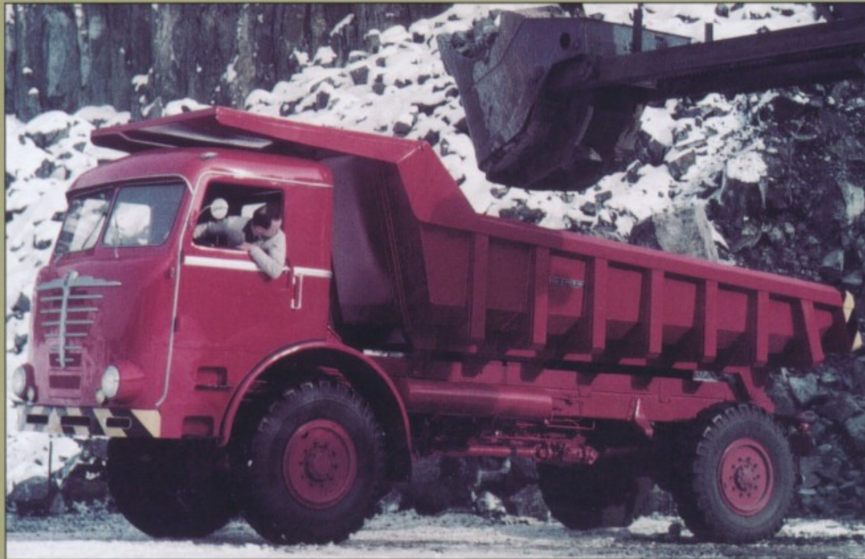
▲ Unterflur und Allrad – ein Widerspruch? Nicht unbedingt, wie der LU 11 A (4x4) von 1958 bewies. Aber der technische Aufwand war beträchtlich. ▼
