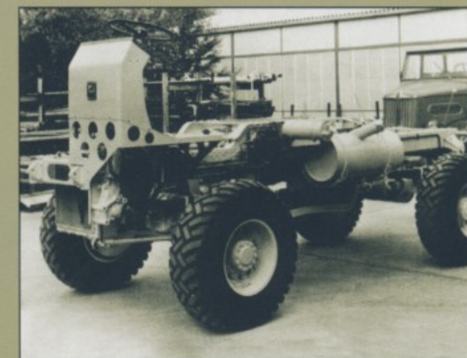
Der Unimog war unschlagbar: Spätestens der komplizierte Büssing Universal (LU 5/10 A) stieß auf der Kostenseite an die Grenzen des Unterflur/Allrad-Konzepts.
