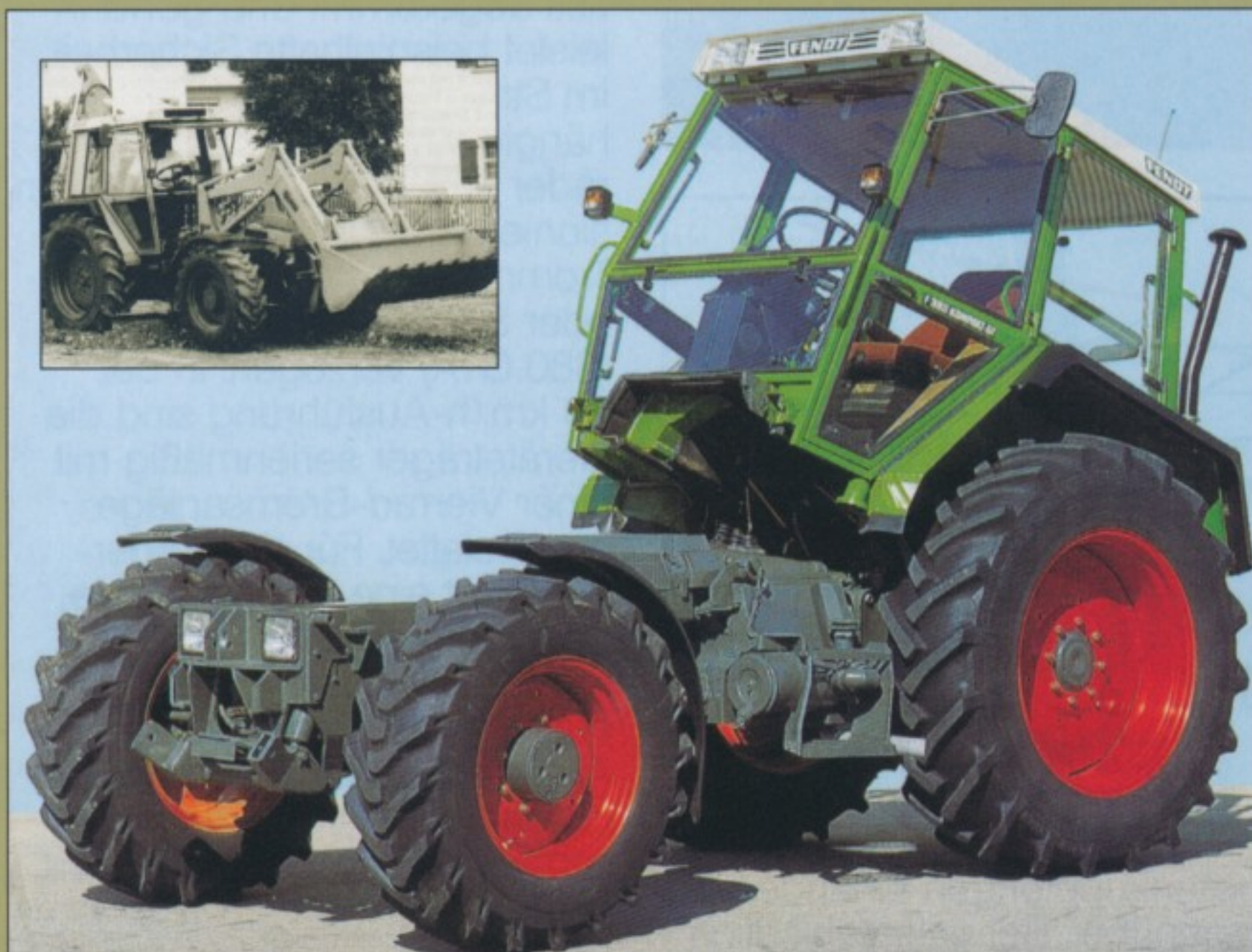
Liegend eingebaute Deutz 4- und 6-Zylinder-Diesel treiben die Fendt-Geräteträger an, die es auch in Kommunalausführung gibt.
