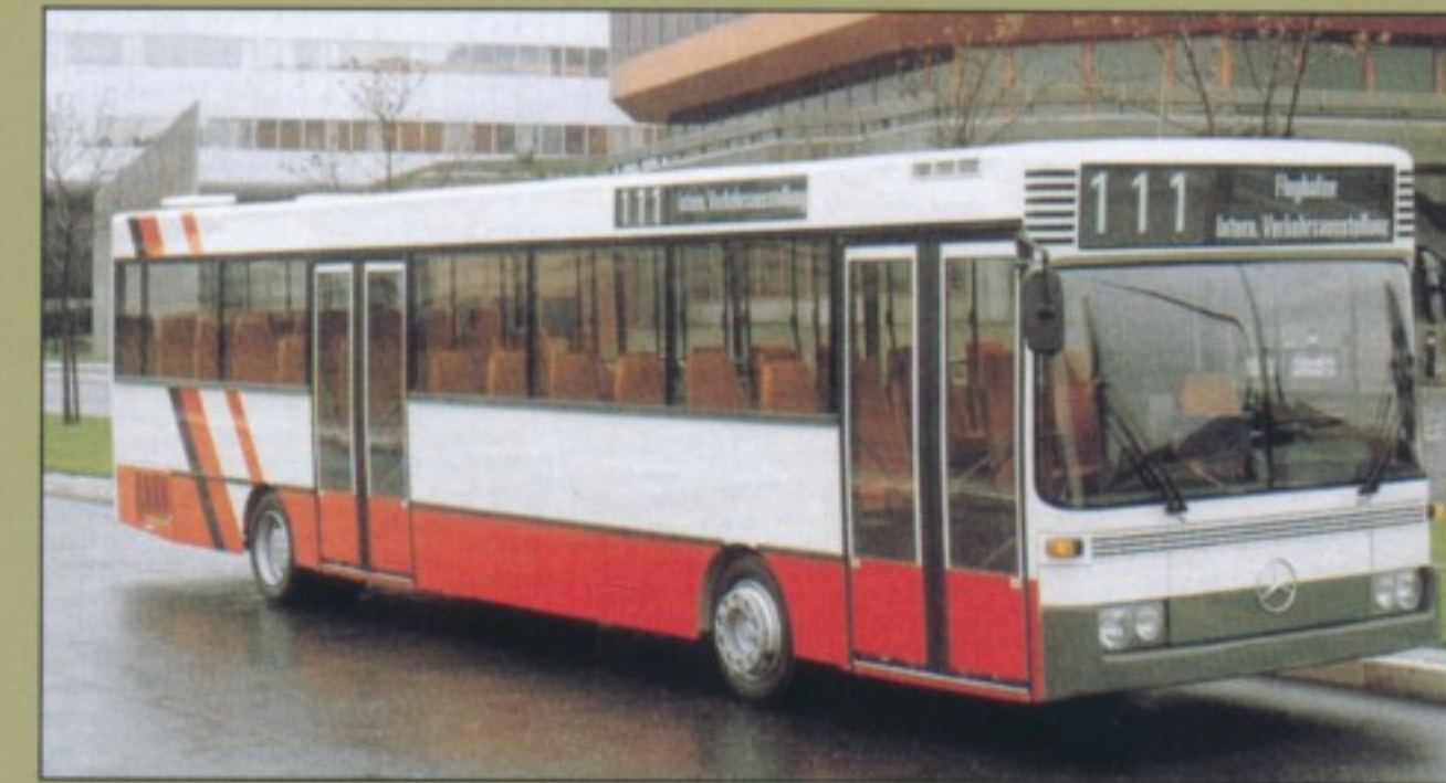
▲ Auf Basis des Mercedes-Benz O 405 erstellte FFG 1984 diesen Niederflrbus mit liegendem OM 407h-Triebwerk.
