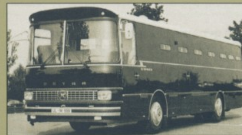
Knacki-Taxe: Ein 240 PS starker Daimler-Benz OM 407 h war unterflur im Heck dieses Setra S 140 ES-K-Gefangenentransporters angeordnet (1975).
