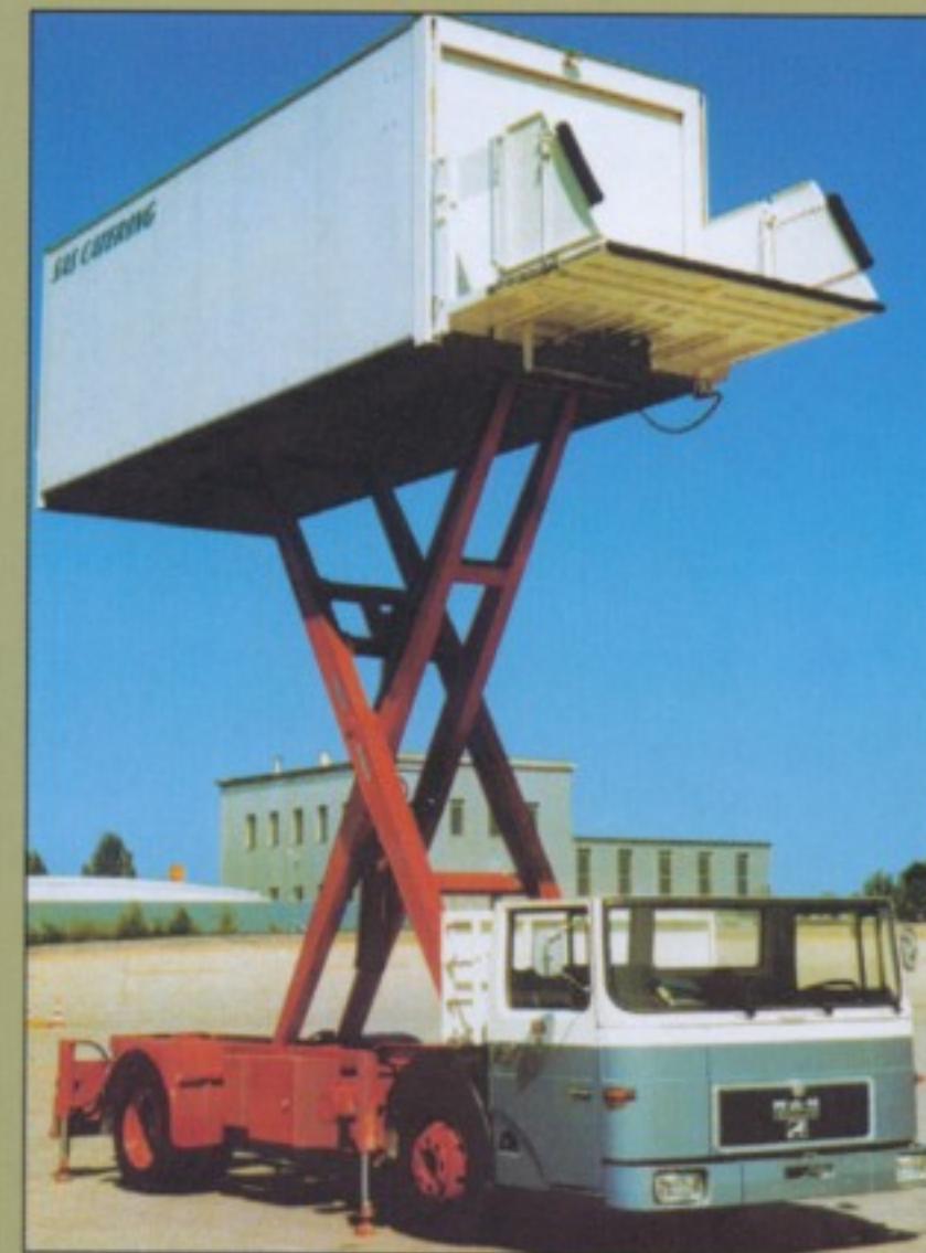
Essen auf Rädern: Scherenhubaufbau von Trepel auf Basis eines MAN/ÖAF 13.136 U.
