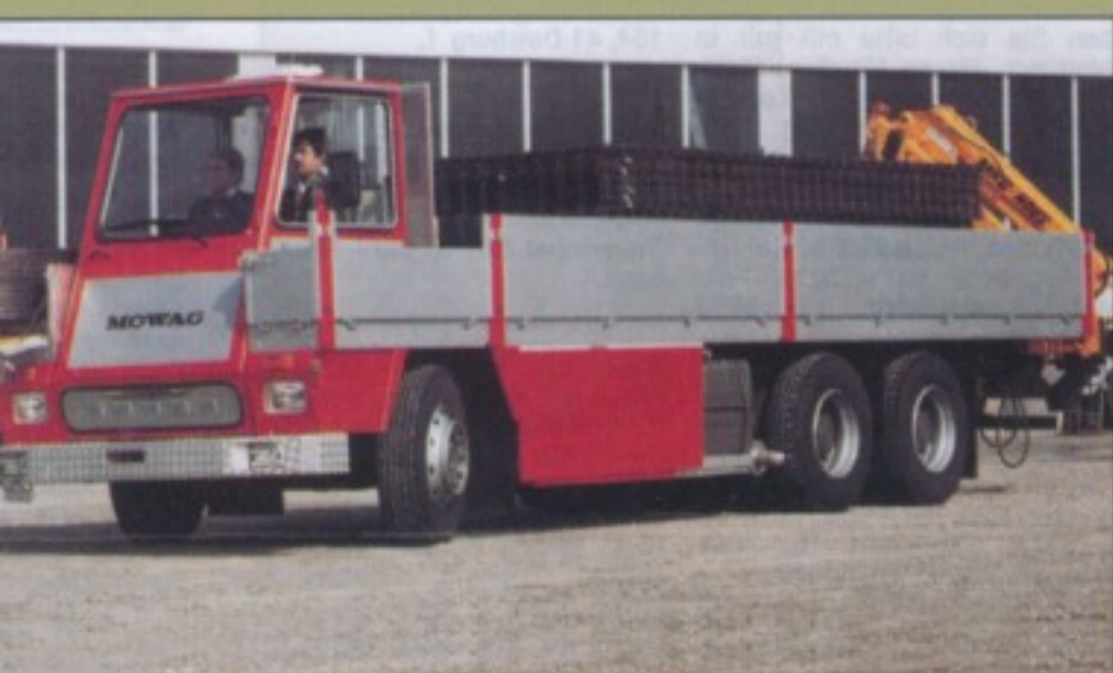
Mowag-Langeisentransporter mit MAN-Unterflurmotor D 2866 MKUL (1987).
