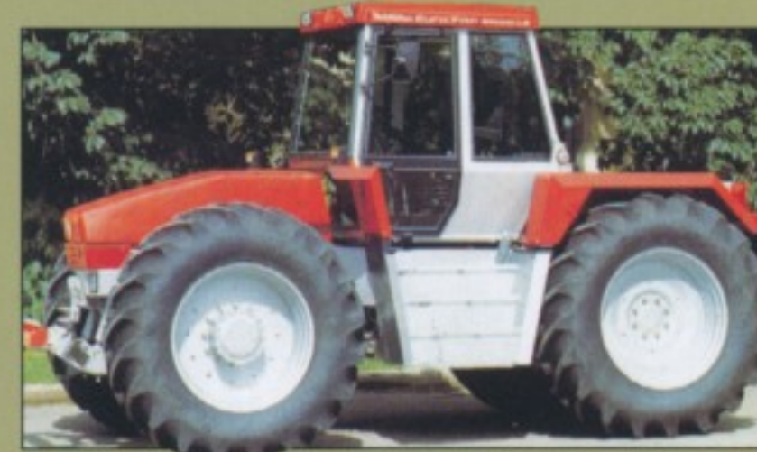
Unterflur pflügen: Der Schlüter/LTS Euro Trac 2000 LS aus dem Jahre 1991 verfügte über einen 200 PS leistenden MAN-Unterflurmotor.
