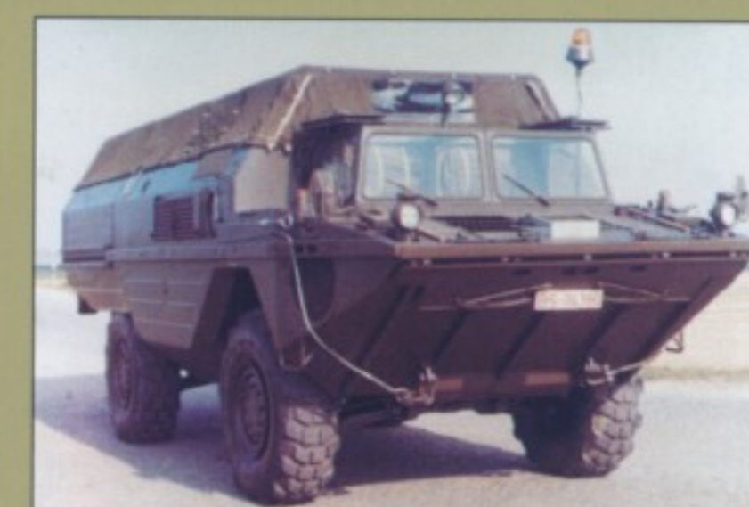
Kleine Stückzahl: Die Bundesmarine erhielt 1967 den Büssing Amphibien-Lastwagen MB-3 mit 218 PS starkem U 11-Direkteinspritzmotor.
