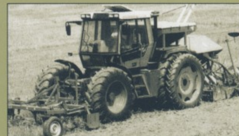
Geräteträger der Zukunft: Fendt Xylon 524 mit MAN-Unterflurmotor D 0824.
