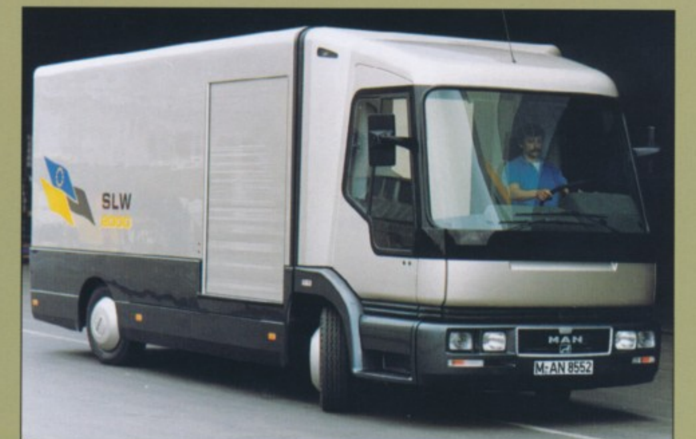
▲ Der erfolgreiche Einfachst-Lastwagen 'Motoporter' mit 30 PS starkem BMW Boxer-Motor (1987) und die geniale MAN-Studie SLW 2000 (1992) mit Unterflur-Frontmotor, Vorderradantrieb und Vierradlenkung waren die vorerst letzten deutschen Versuche, Lastwagen mit Unterflurmotor zu bauen. ▼
