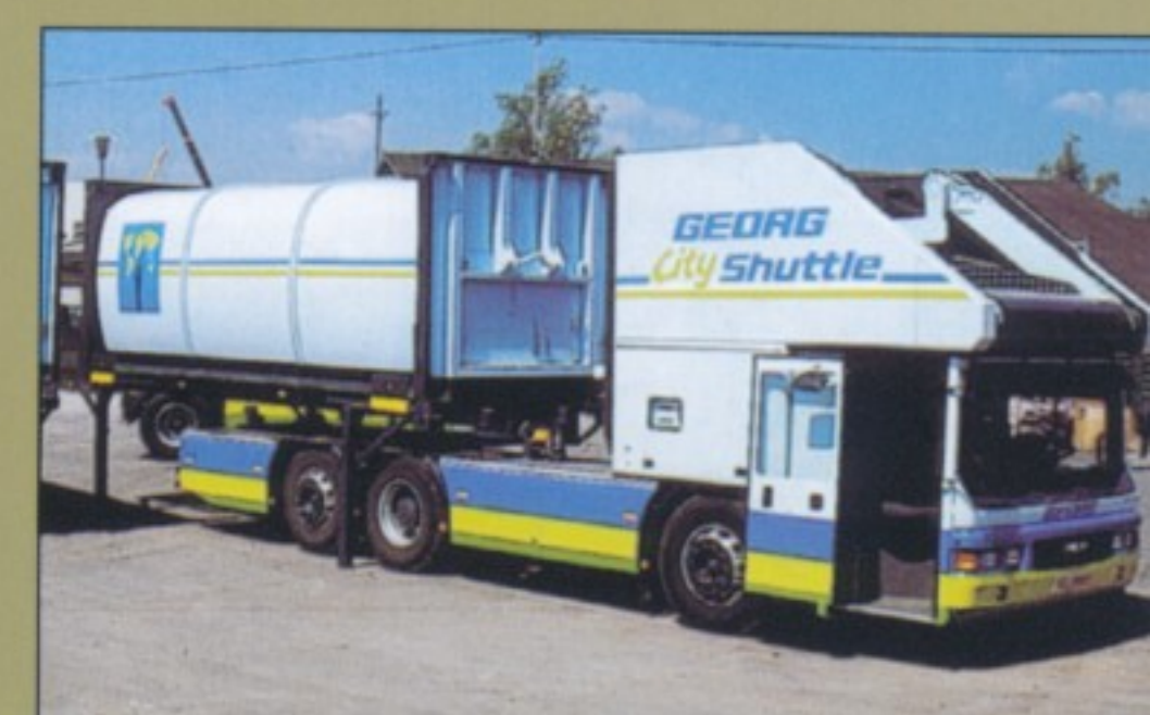
Zu schön für einen Müllwagen: Georg 'City Shuttle' auf Neoplan-Chassis mit MAN-Unterflurmotor.
