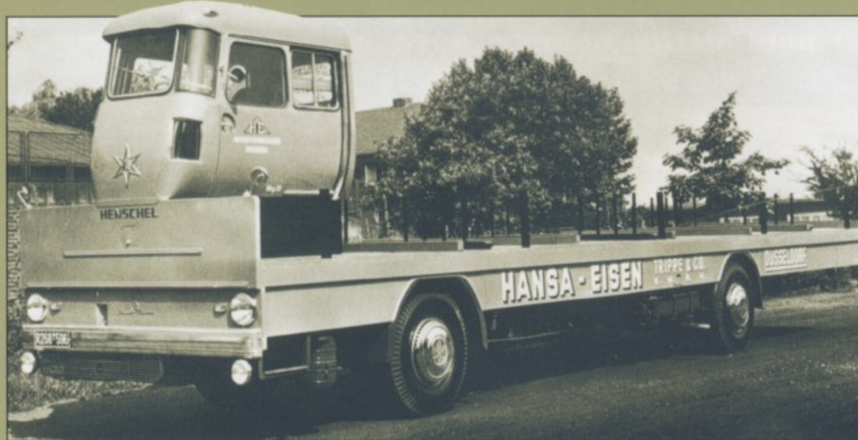
Ideale Nische: Spezialfahrzeuge für den Langeisentransport nutzten die Vorteile der Unterflur-Technik. Im Bild eine Kässbohrer-Konstruktion auf Basis des Omnibus-Fahrgestells HS 200 UN von Henschel (1955).
