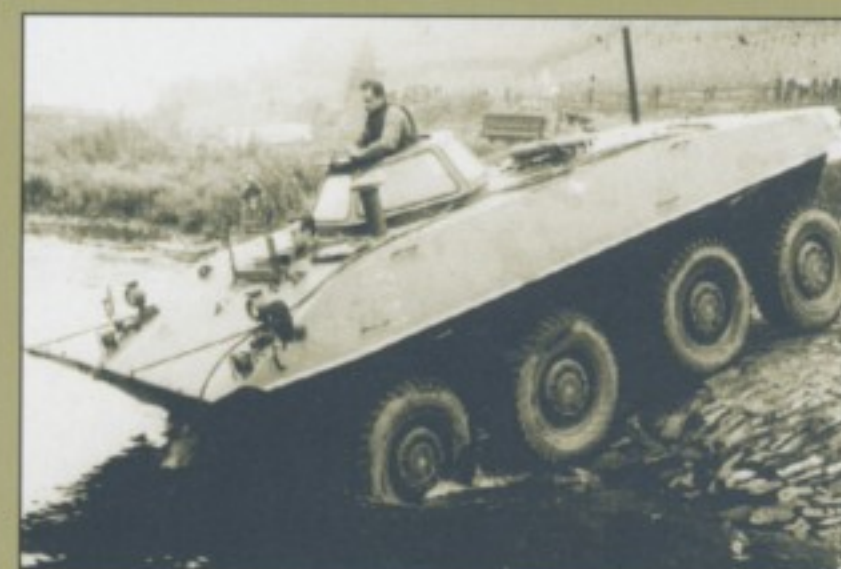
Tauchte in der Versenkung ab: Von Büssing 1961 für die Bundeswehr entwickelter 8-Rad-Spähpanzer mit aufgeladenem U 11-Motor und 220 PS.
