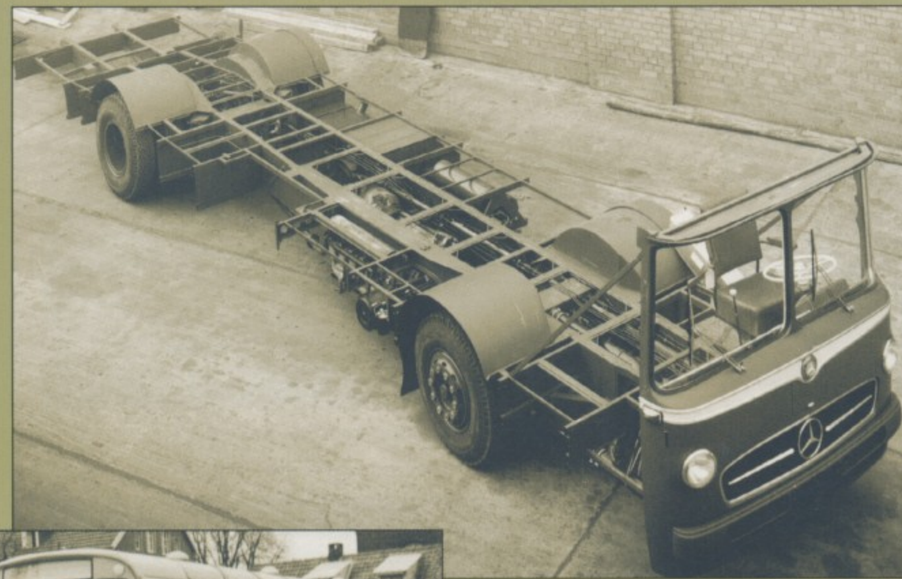
◀ ◀ Mit seinem Unterflurmotor war das Mercedes-Benz Omnibus-Fahrgestell O 317 K die ideale Basis für Bus- und Sonderaufbauten aller Art.
