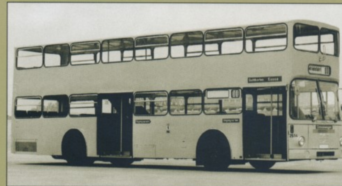
Jroßer Jelber: Dieser 1973 an die Berliner BVG gelieferte MAN-Büssing SD 200 wurde von einem 192 PS leistenden MAN-Unterflurmotor D 2556 MXUH angetrieben.
