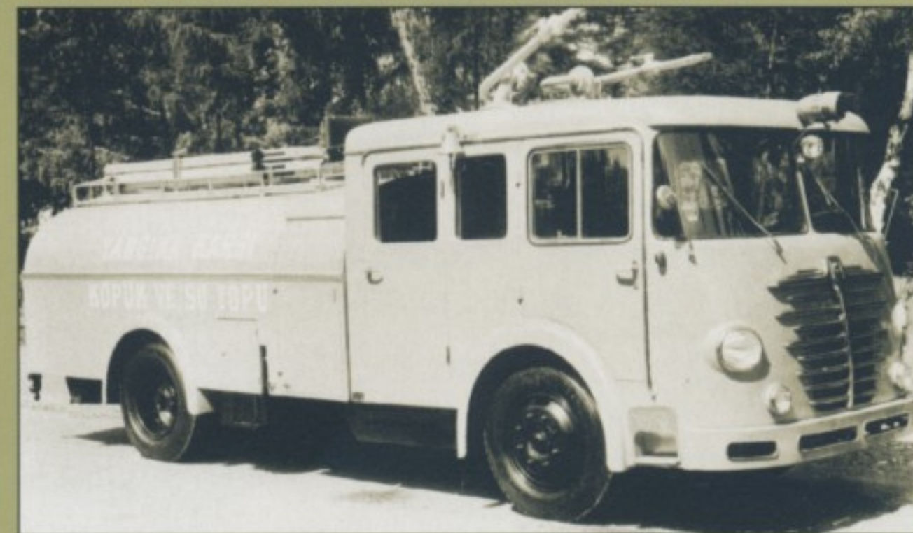
Unterflur-Feuerwehr: 1954 von Luchterhand & Freytag für die Türkei aufgebautes Tanklöschfahrzeug auf Büssing 4000-Chassis.
