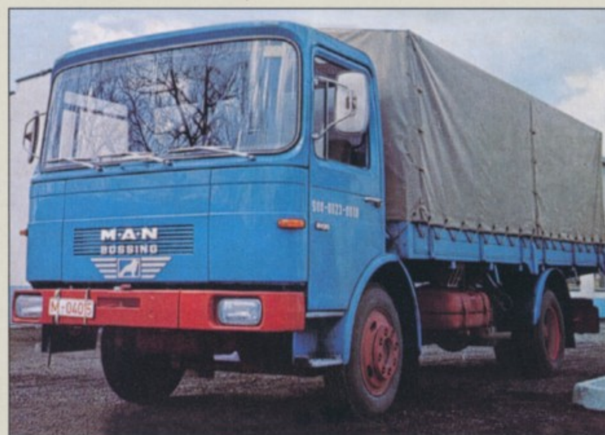
▲ Einer der letzten MAN-Unterflur-Lastwagen war der 19.422 U/UL mit dem 420 PS-Motor D 2866 LU 04.
