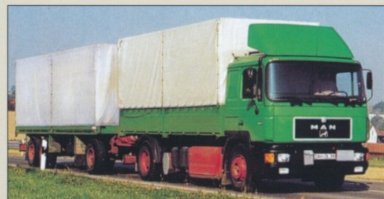
▲ Einer der letzten MAN-Unterflur-Lastwagen war der 19.422 U/UL mit dem 420 PS-Motor D 2866 LU 04.
