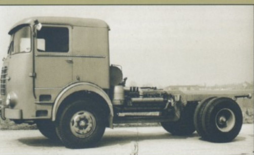
Unterflur-Sattelzugmaschine, die Erste: Dieser 1963 gebaute LU 11/16 mit um 180° gedrehtem Motor kam über das Prototypenstadium nicht hinaus.
