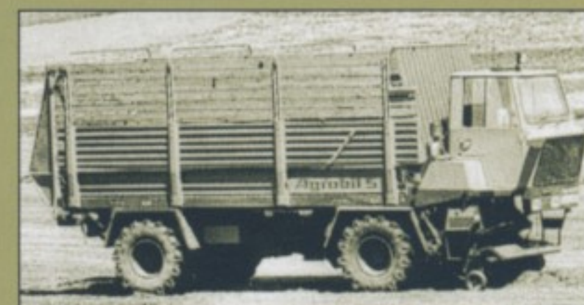
Lademeister: Der Fendt Agrobil S wurde zwischen 1971 und 1984 gebaut und von einem liegenden Deutz-Diesel mit 80 PS angetrieben.
