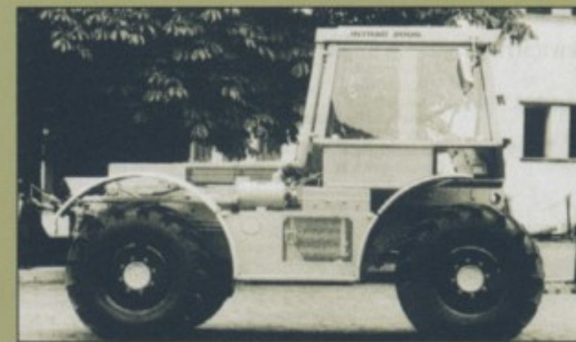
Nur 1975 gebaut: Der Deutz Intrac 2006 blieb der einzige Deutz-Schlepper mit Unterflurmotor.
