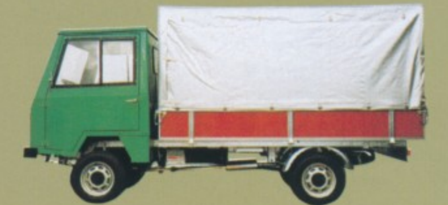
▲ Der erfolgreiche Einfachst-Lastwagen 'Motoporter' mit 30 PS starkem BMW Boxer-Motor (1987) und die geniale MAN-Studie SLW 2000 (1992) mit Unterflur-Frontmotor, Vorderradantrieb und Vierradlenkung waren die vorerst letzten deutschen Versuche, Lastwagen mit Unterflurmotor zu bauen. ▼
