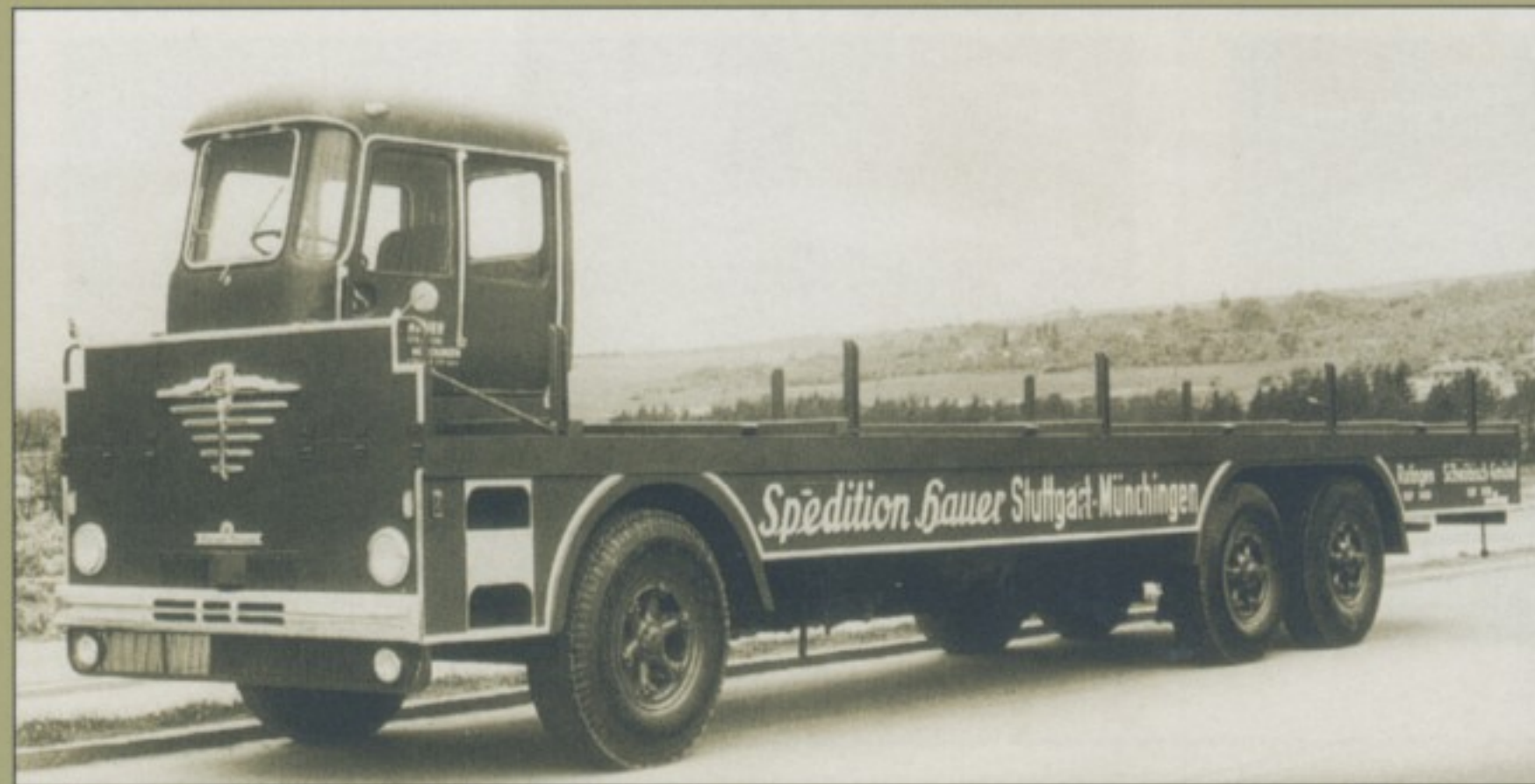
Beste Übersicht für den Fahrer: Büssing 12000 mit Langmaterialaufbau von Kässbohrer.
