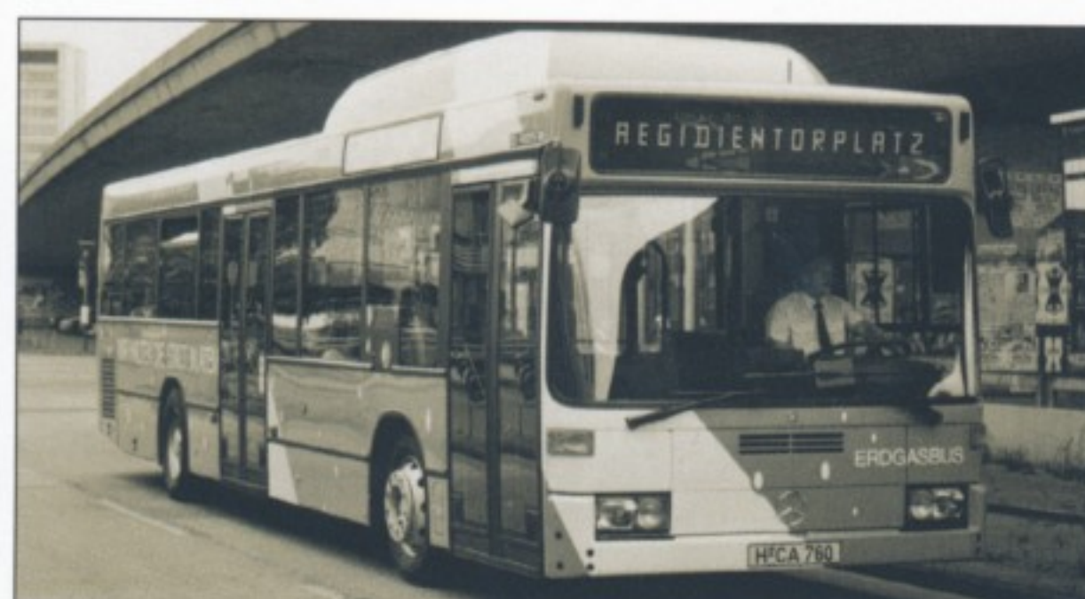
1995: Mercedes-Benz O 405 NG mit Erdgasantrieb.
