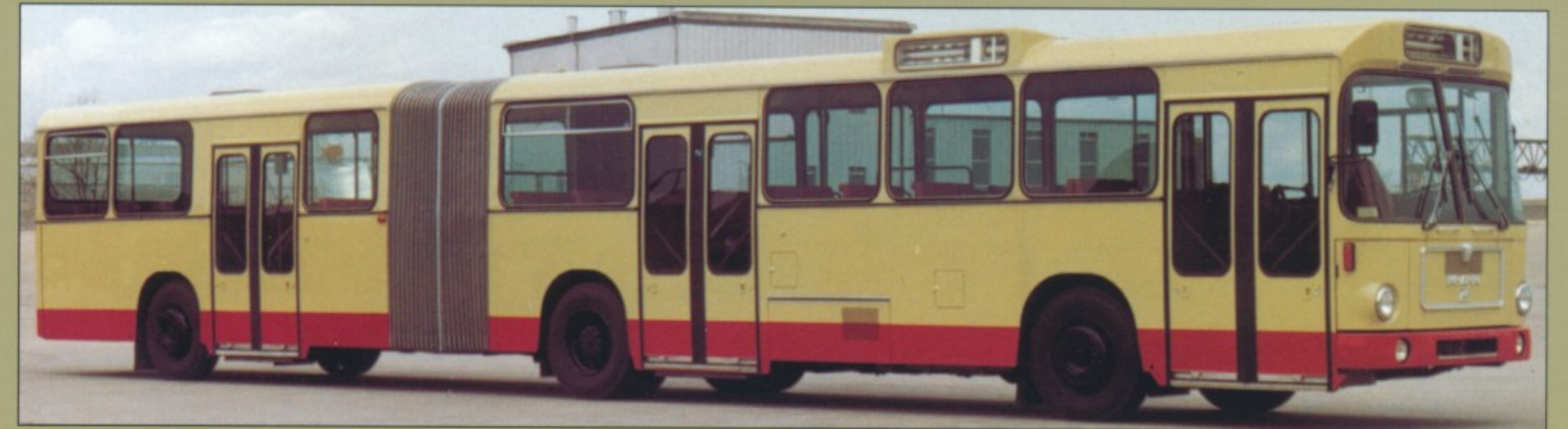
MAN/Göppel-Gelenkzug mit angetriebener Mittelachse und seitlich im Vorderwagen liegendem Unterflurmotor.
