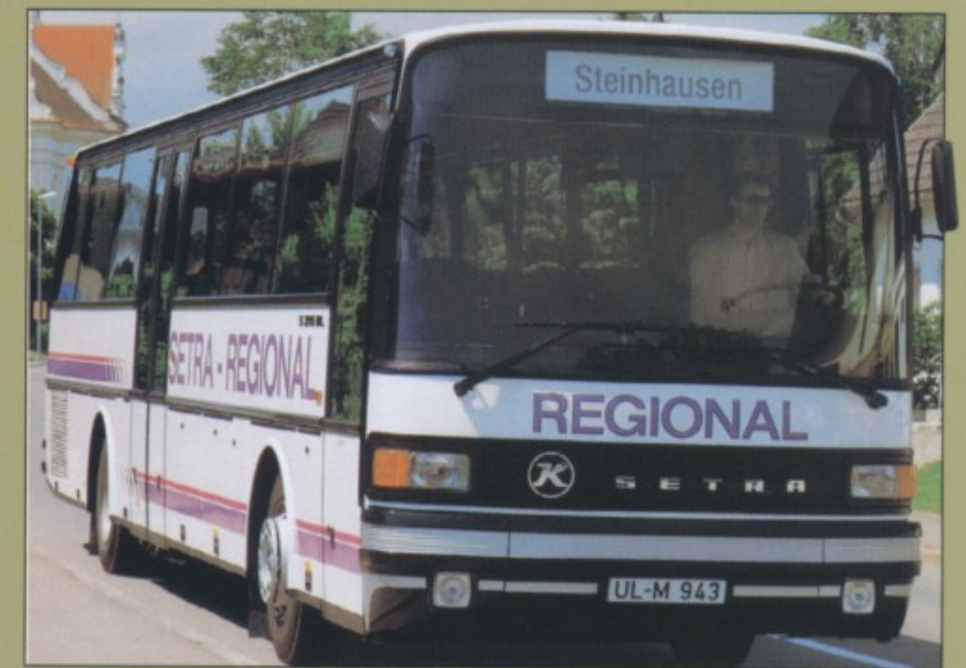
Qual der Wahl: In den Setra S 215 UL wurden, je nach Kundenwunsch, Unterflurtriebwerke von MAN oder Daimler-Benz eingebaut. ▶
