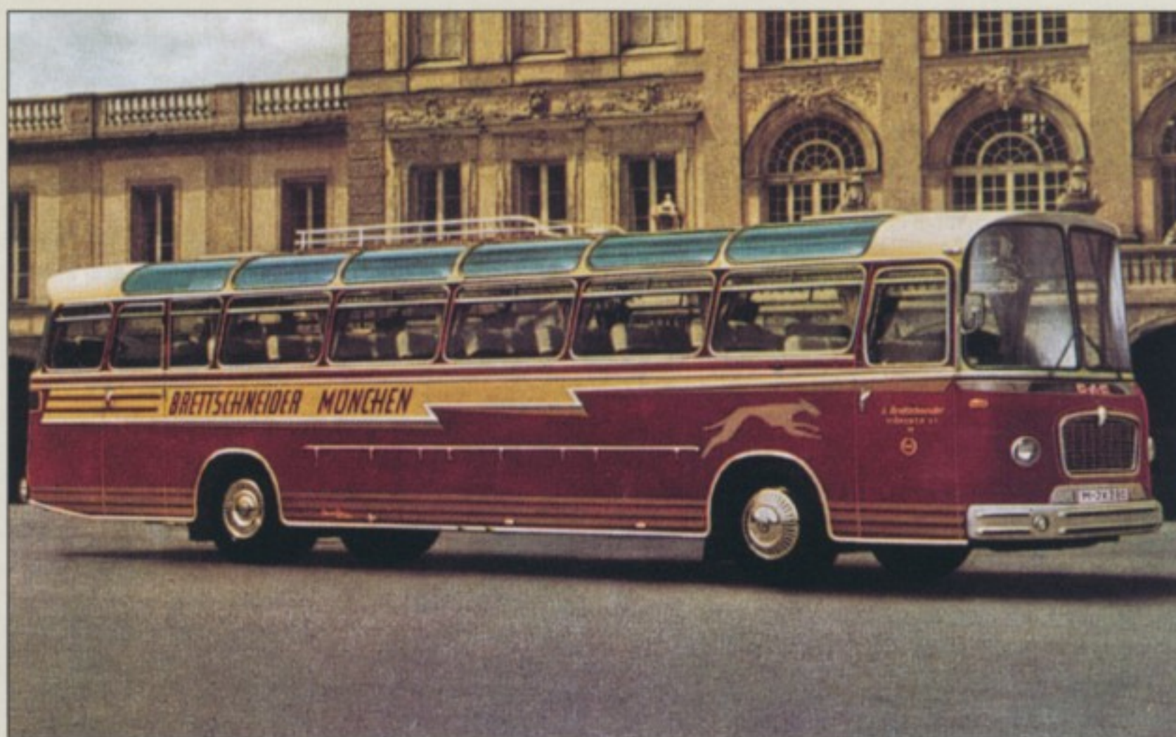
Der 760 UO 1 war ab 1957 das erste MAN-Straßenfahrzeug mit Unterflurmotor.
