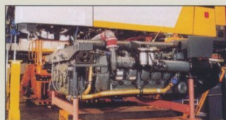
In Schienen-Triebwagen leisten MAN-Unterflurmotoren heute bis zu 1000 PS.
