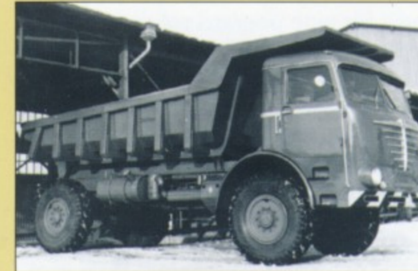
Mit 18 Tonnen Gesamtgewicht bewegte sich auch der 1958 vorgestellte Büssing LU 11 A (4x4) außerhalb der deutschen StVZO seiner Zeit.
