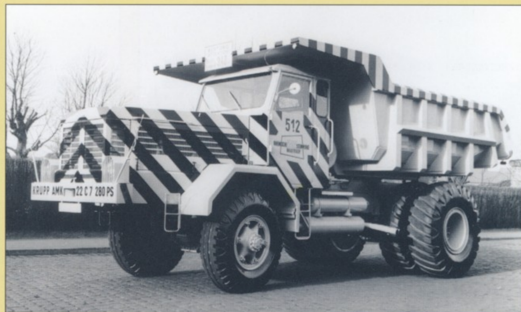
◀ Zebra-Design: Krupp MK 19 C 6 Gigant (4x2) als 2-Seiten-Muldenkipper ohne Allradantrieb.
