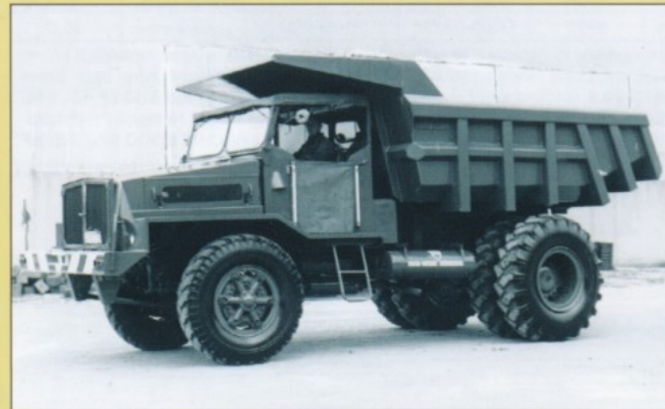
Faun K 20 – ein Thema mit Variationen: K 20 (4x2) von 1953 mit Sechszylinder-Motor und automatischer Heckklappe, K 20 (4x2) von 1955 mit luftgekühltem V-Zwölfzylinder von KHD und beheizter Meiller-Mulde, seltener K 20 (4x2) mit KHD-V8 und entsprechend verkürzter Haube, und K 20/41(4x2) von 1958 mit spezieller Felsmulde von Meiller (von li. n. re.).
