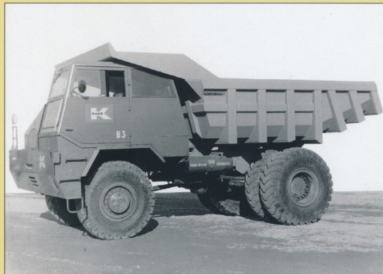
Allrad-Variante: K 20/38 VA mit Meiller-Mulde, ebenfalls für die Baufirma Kunz.
