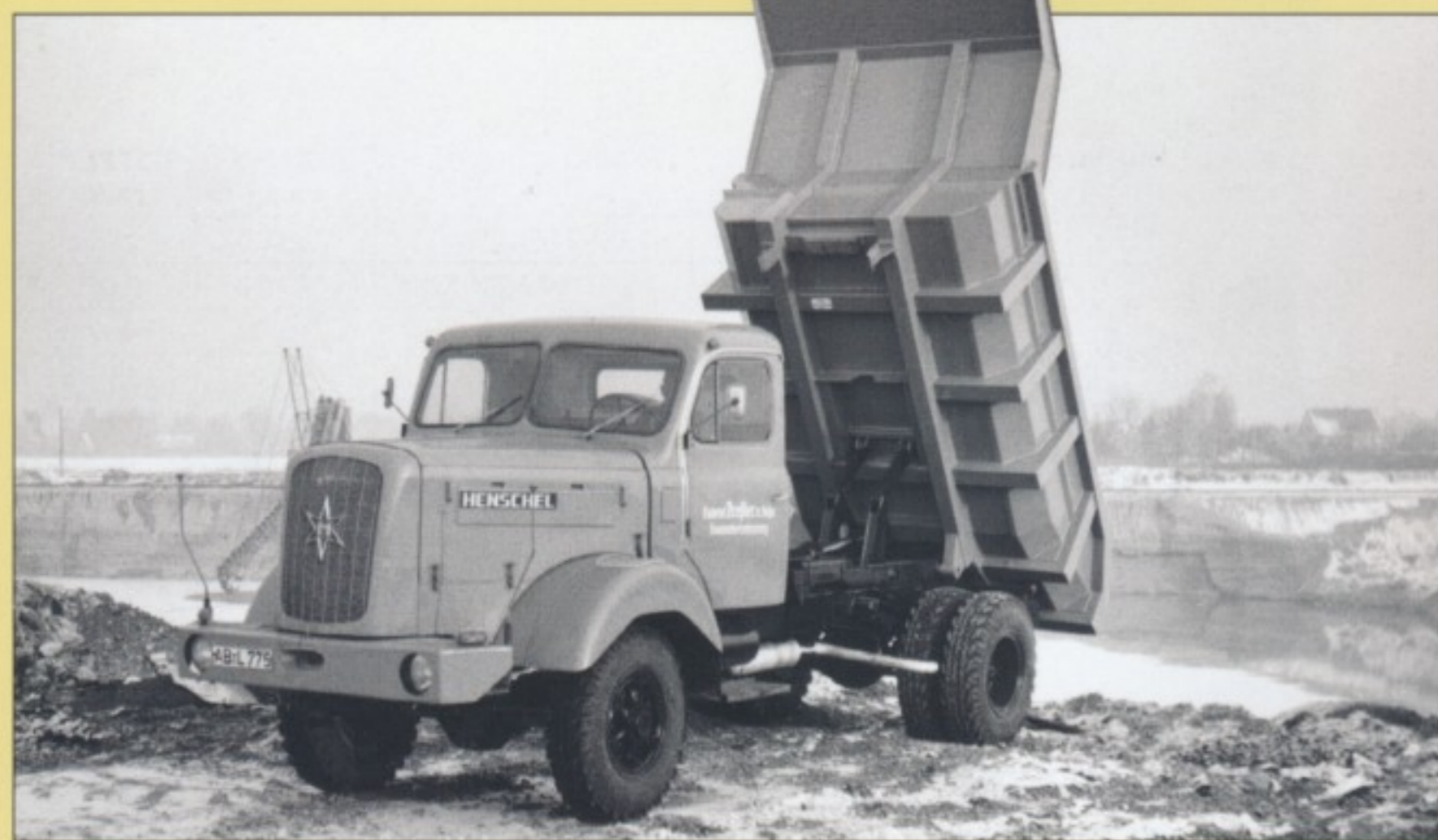
▲ Auch Henschel bot 1959 eine Variante des HS 140 AK an, die für 18 Tonnen Gesamtgewicht ausgelegt war.
