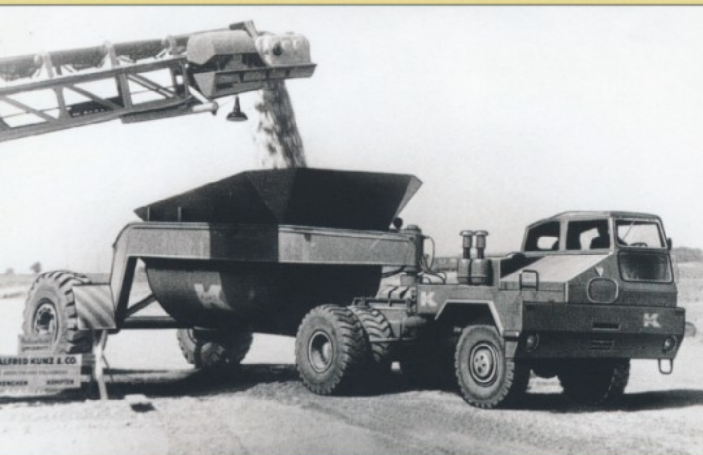
Einzelstück: Für Alfred Kunz & Co. war dieser K 20/38 VSA (4x4) als Zugmaschine für einen Mulden-Bodenentleerer bestimmt.
