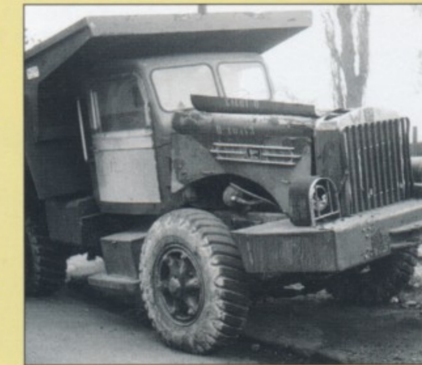
Vorbildfunktion: Der erste dieselgetriebene Muldenkipper von Euclid 1936.
