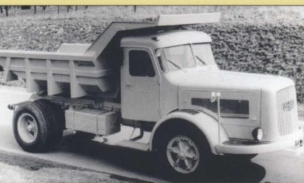
Weißer Riese: Der K 680 SE (4x2) war Kaelbles Beitrag zu den Muldenkippern mit eingeschränkter Straßentauglichkeit.
