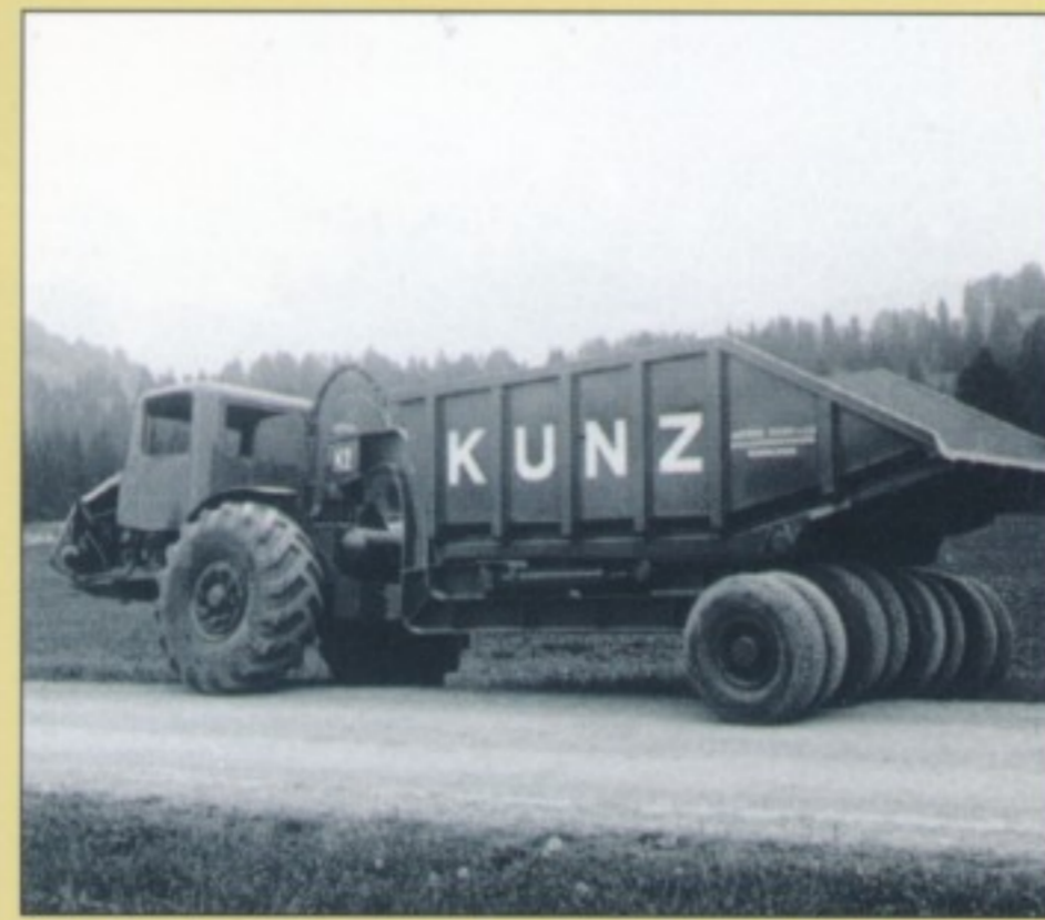
Erfolgreicher Exot: Der Kunz K2 „Kuki“, Deutschlands erster Muldenkipper mit Knicklenkung.
