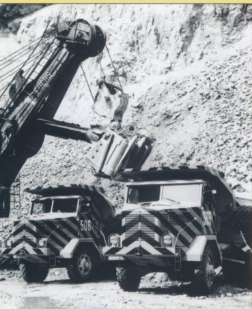
◀ Zebra-Design: Krupp MK 19 C 6 Gigant (4x2) als 2-Seiten-Muldenkipper ohne Allradantrieb.
