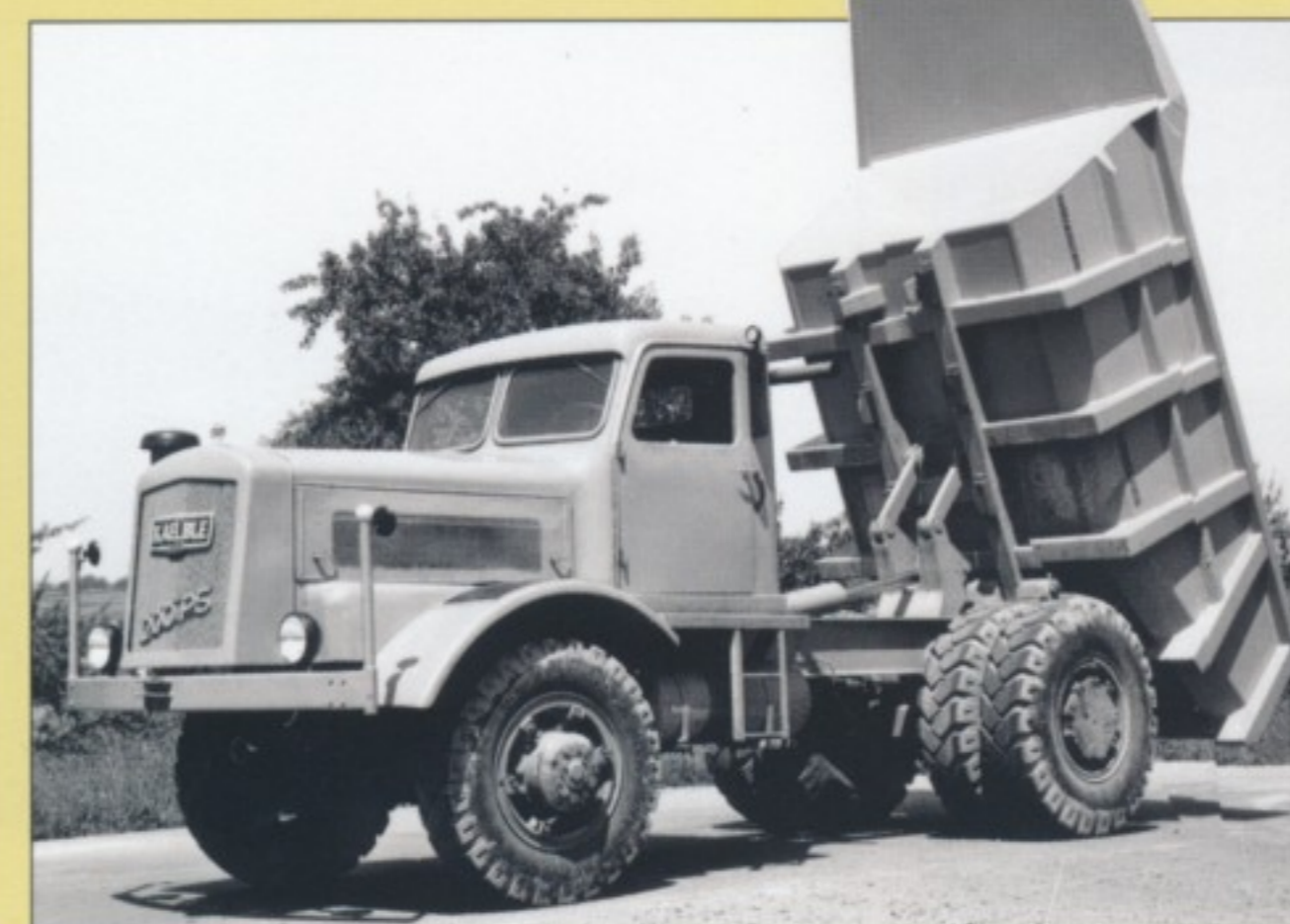
Alternativen zum Dreiachser: Kaelble KV 832 E/16 (links) und KV 832 E/20 von 1953/54, mit Meiller-Mulden und Allradantrieb.
