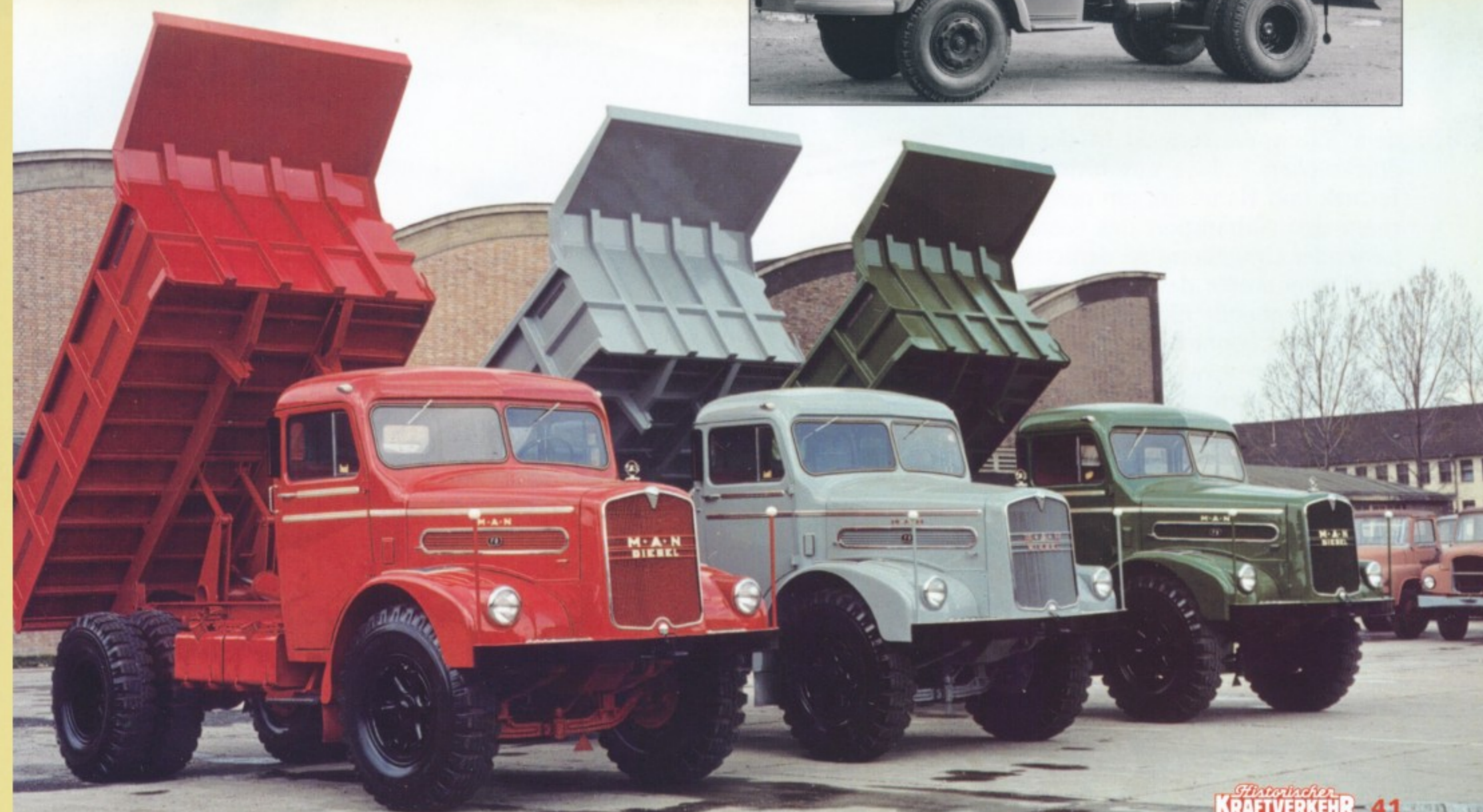
Kantiges Urviech: Der ab 1956 gebaute Krupp AK 11 Dr 4 Drache (links) erhielt ab 1959 einen Fünfzylinder-Zweitaktmotor und hieß AK 11 Dr 5, im Bild mit 3-Seiten-Flachmulde.
