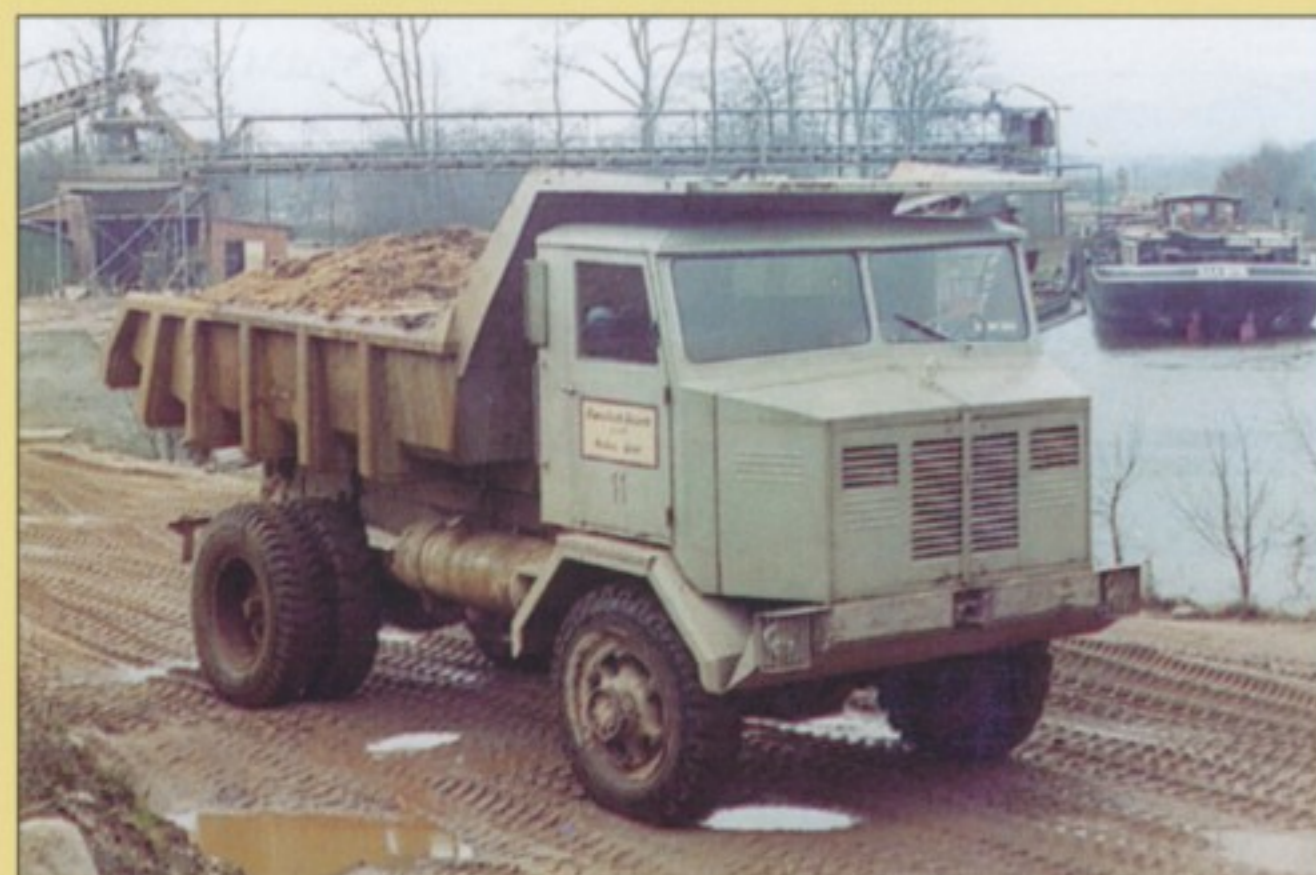
Kantiges Urviech: Der ab 1956 gebaute Krupp AK 11 Dr 4 Drache (links) erhielt ab 1959 einen Fünfzylinder-Zweitaktmotor und hieß AK 11 Dr 5, im Bild mit 3-Seiten-Flachmulde.
