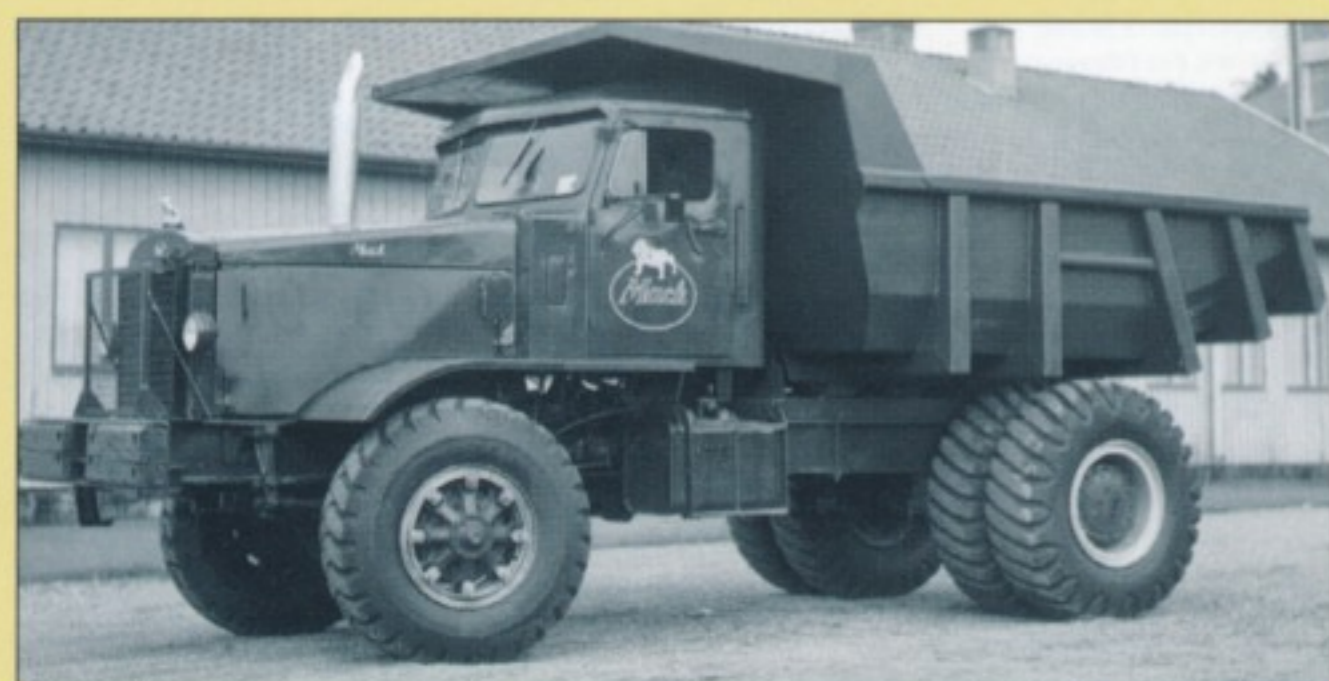
Vom Vorbild zum Konkurrenten: Ein deutscher Kunde erhielt 1953 diesen Mack LV (4x2) mit Meiller-Mulde für ein Gesamtgewicht von 39,5 Tonnen.
