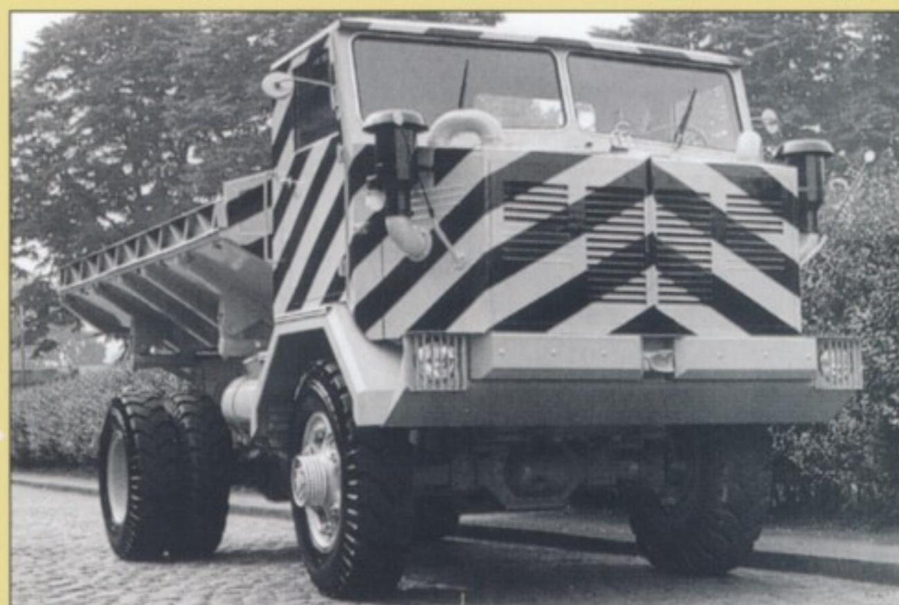
Kantiges Urviech: Der ab 1956 gebaute Krupp AK 11 Dr 4 Drache (links) erhielt ab 1959 einen Fünfzylinder-Zweitaktmotor und hieß AK 11 Dr 5, im Bild mit 3-Seiten-Flachmulde.
