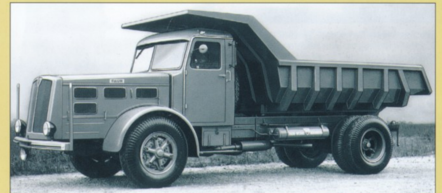
Die Mulde ist kaum länger als die Haube: Faun L8/49 K (4x2) aus dem Jahr 1954.
