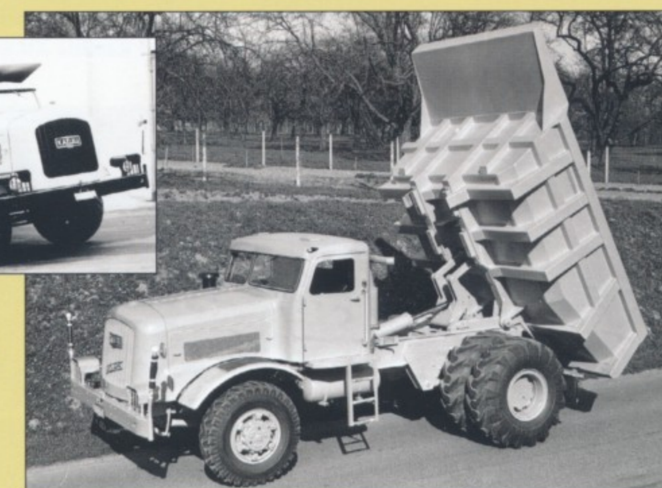
Alternativen zum Dreiachser: Kaelble KV 832 E/16 (links) und KV 832 E/20 von 1953/54, mit Meiller-Mulden und Allradantrieb.
