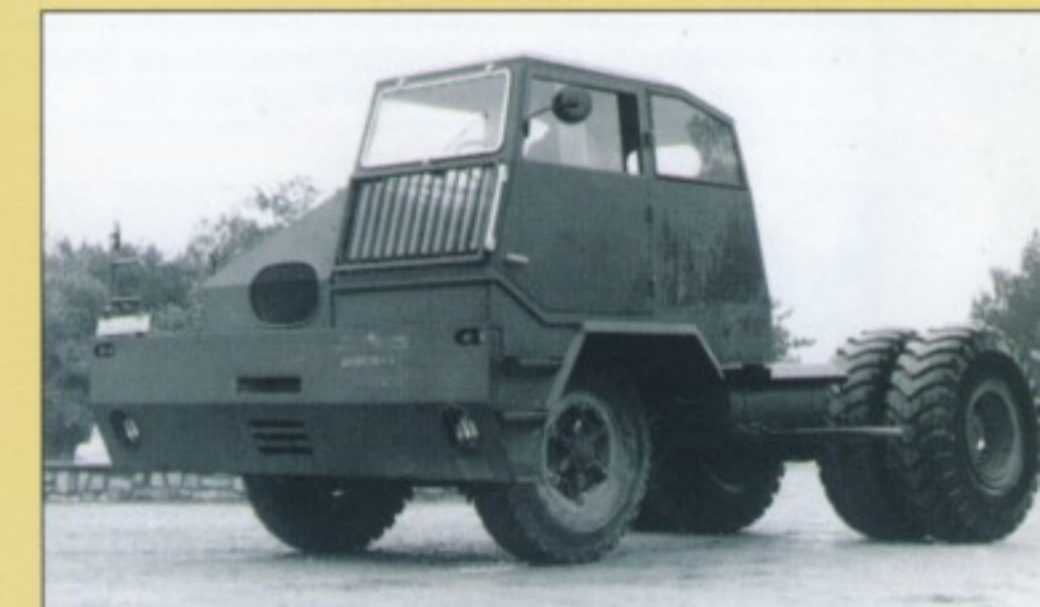
Der K 20/38 V (4x2) war der haubenlose Bruder des K 20. Hier das erste Serienfahrzeug noch ohne Mulde auf Erprobungsfahrt.
