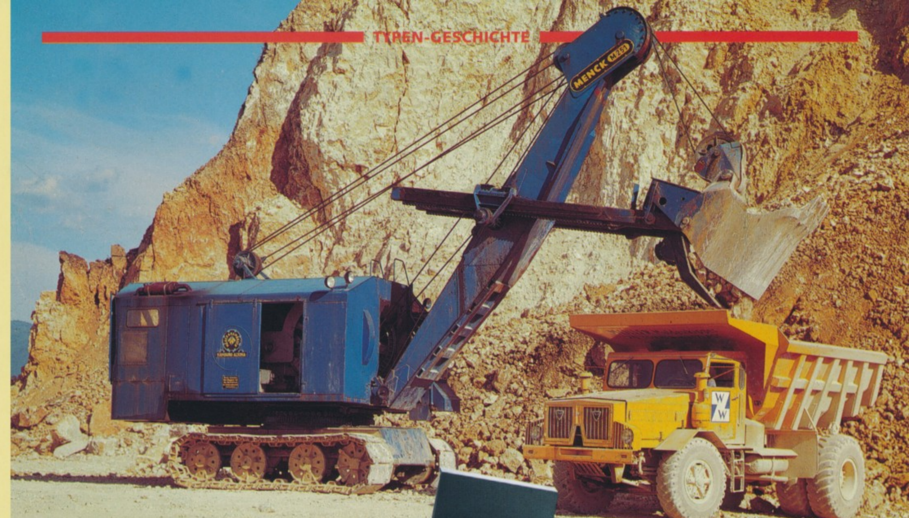
▲ Dauerbrenner: Obwohl er nur mit Hinterradantrieb lieferbar war, hielt sich der K 20 ein ganzes Jahrzehnt im Faun-Programm. Im Bild ein Exemplar mit V12-Motor und Meiller-Felsmulde zusammen mit einem Menck M 251.
