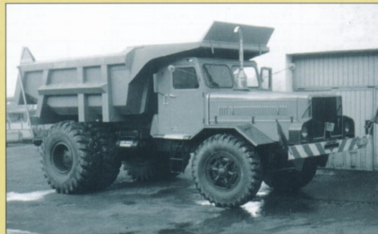
K 20 'light': Der 1957 vorgestellte Faun K 15/41 (4x2) war für 15 Tonnen Nutzlast ausgelegt. ▶
