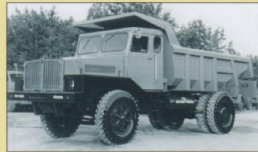
K 20 'light': Der 1957 vorgestellte Faun K 15/41 (4x2) war für 15 Tonnen Nutzlast ausgelegt. ▶
