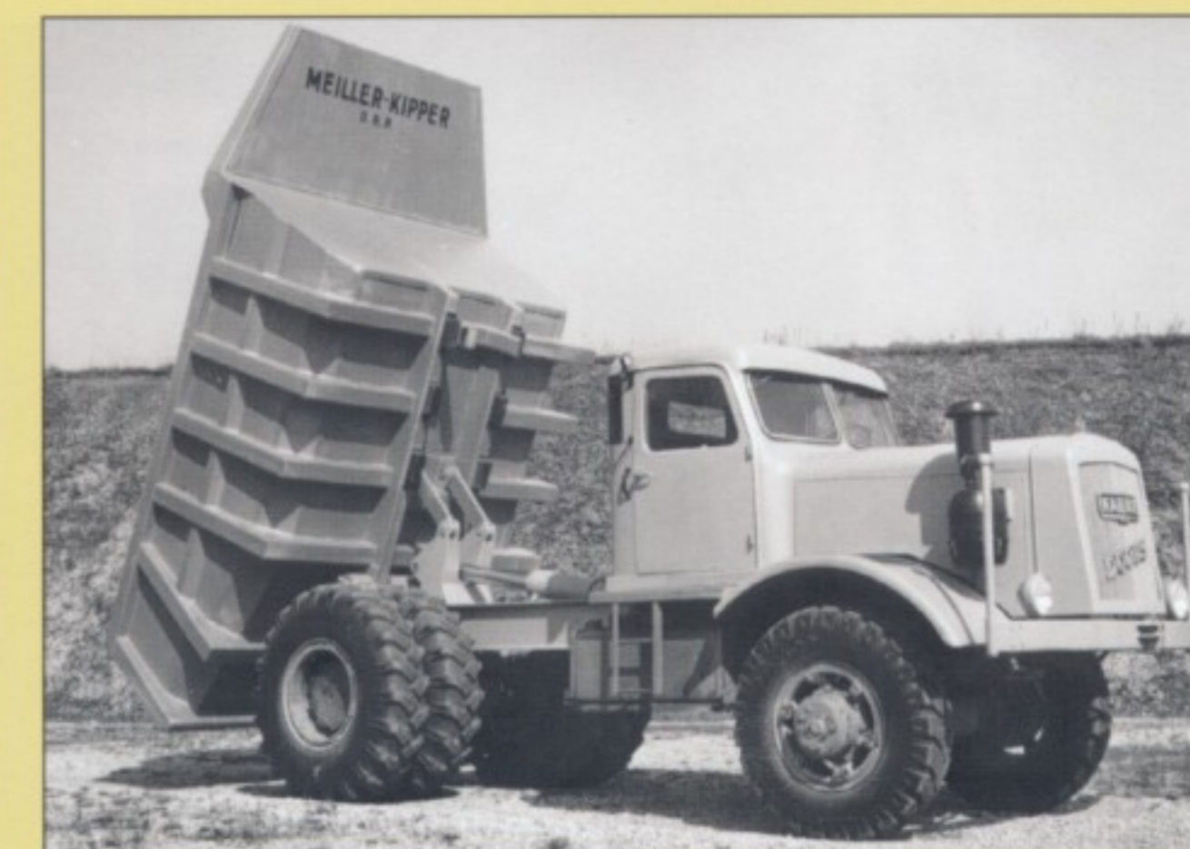
Alternativen zum Dreiachser: Kaelble KV 832 E/16 (links) und KV 832 E/20 von 1953/54, mit Meiller-Mulden und Allradantrieb.
