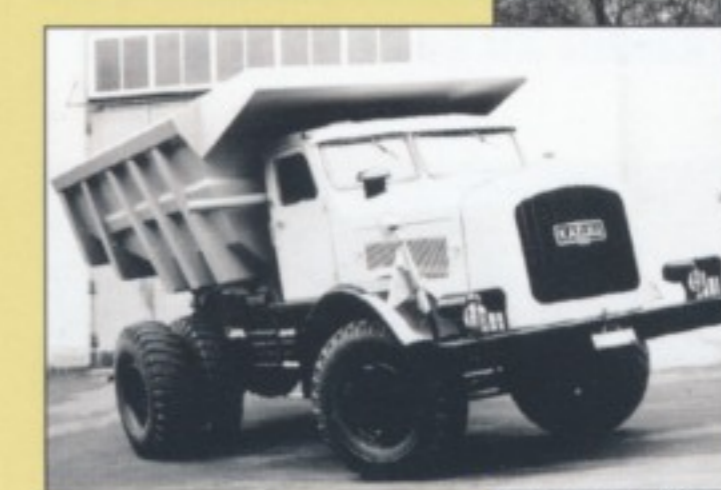
Mit und ohne Allrad: Der K 635 E (4x2), hier mit Felsmulde von Meiller, erschien bereits 1958, sein Allrad-Pendant KV 635 E (gr. Bild) folgte im Jahr darauf.
