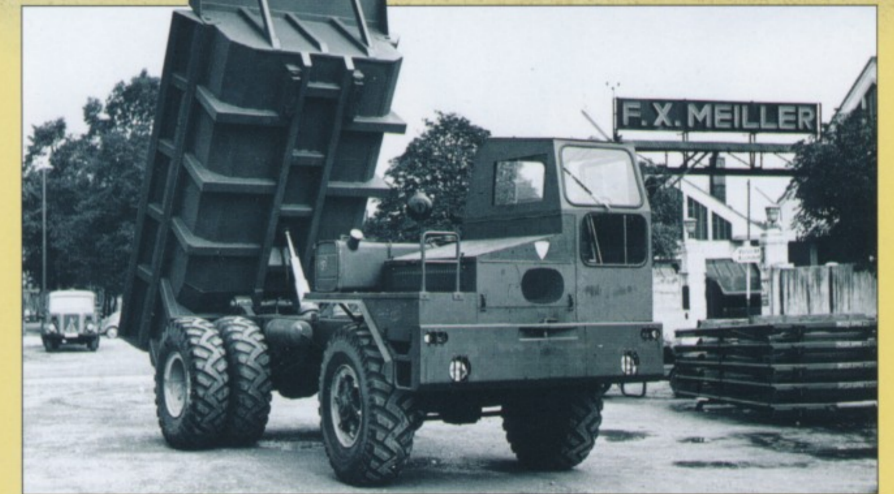
Die Frontlenker kommen: Der erste, noch unlackierte Faun K 15 VA (4x4) 1957 auf dem Werksgelände von Meiller in München. 170 Deutz-Pferde standen 15 Tonnen Nutzlast gegenüber.
