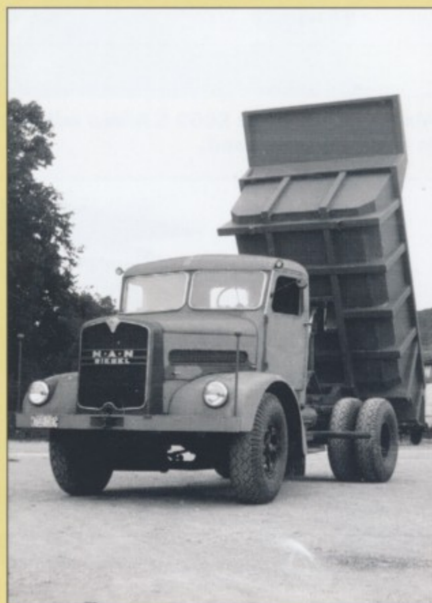
In der ab 1951 gebauten ersten Ausführung waren für den MAN F8-Muldenkipper 19 Tonnen Gesamtgewicht zulässig.
