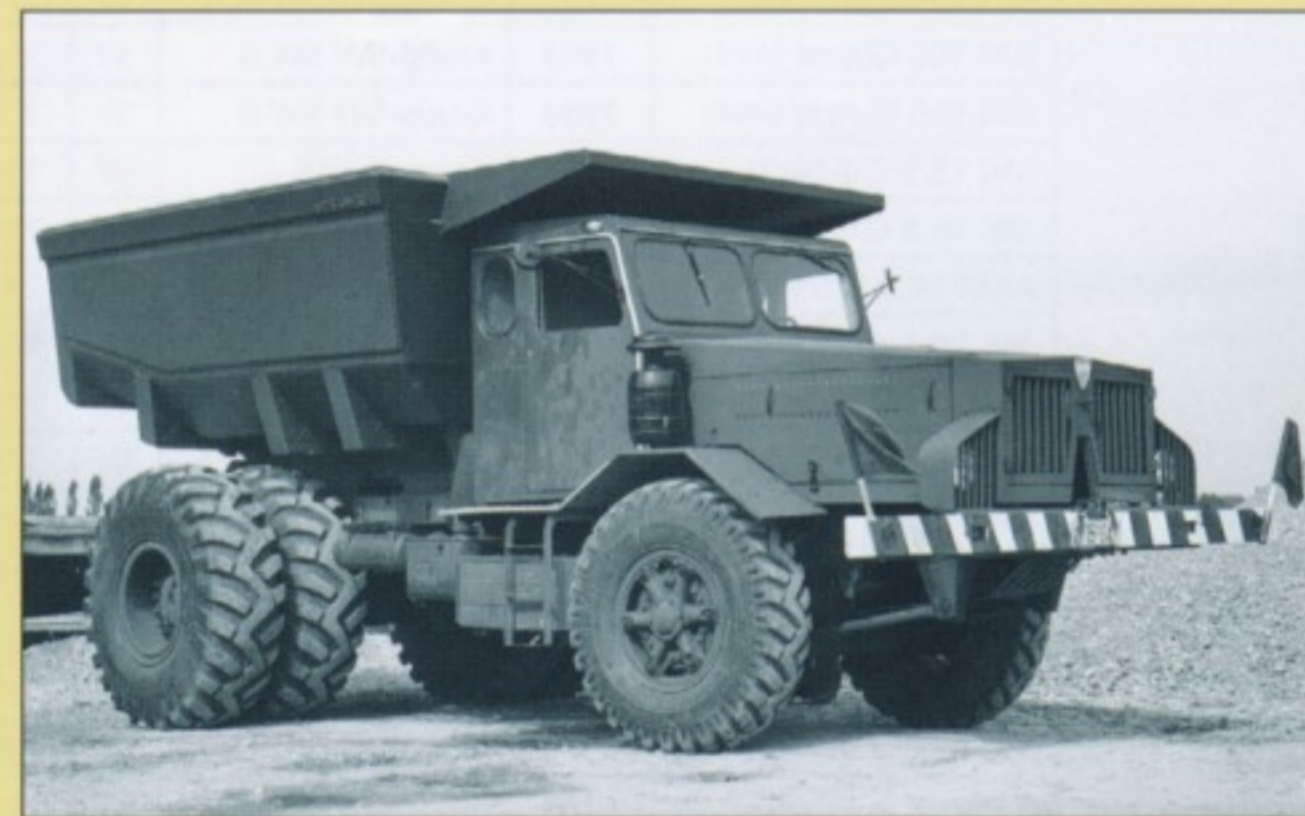
K 20 'light': Der 1957 vorgestellte Faun K 15/41 (4x2) war für 15 Tonnen Nutzlast ausgelegt. ▶
