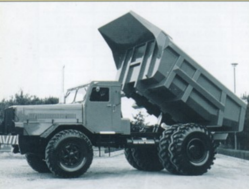
Nürnberger Koloss: Die endgültige Ausführung des K 20 mit wassergekühltem KHD-Reihensechszylinder, erkennbar am Auspuff auf der Motorhaube.
