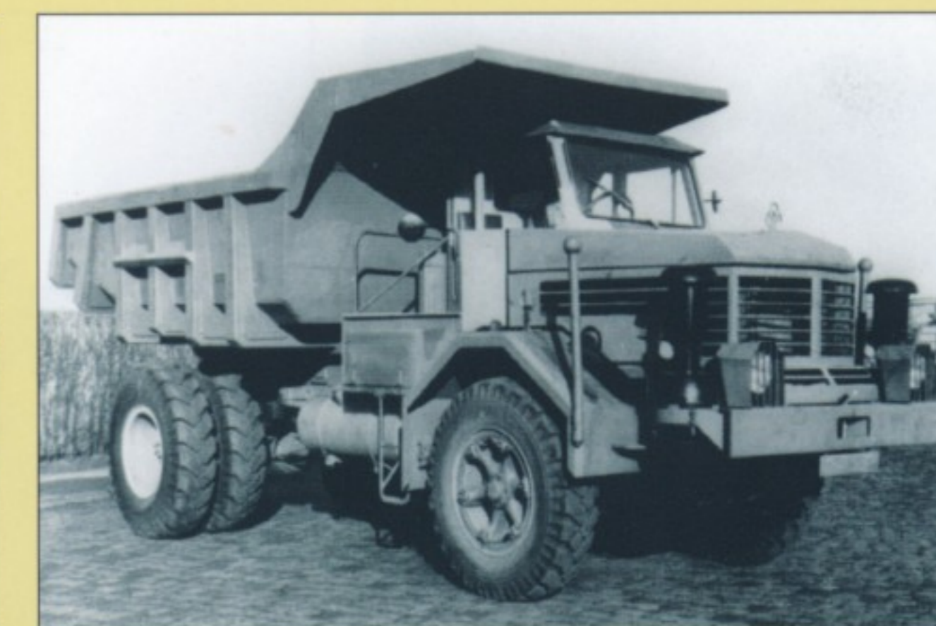
1959 war er tatsächlich einäugig: MK 15 C 5 Cyclop (4x2) mit Einmann-Kabine.
