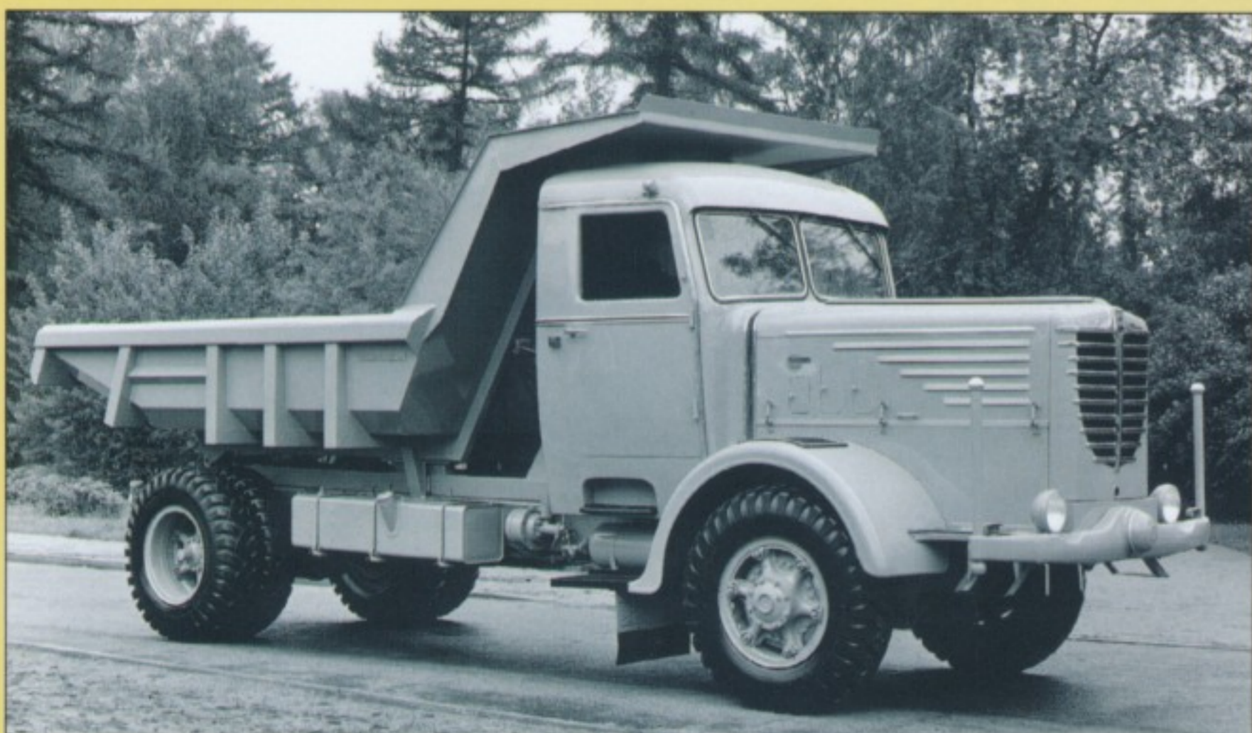
Mit dem 8000 S Allrad gehörte Büssing ab 1954 zu den ersten Anbietern von schweren Muldenkippern auf modifizierten Serien-Fahrgestellen.
