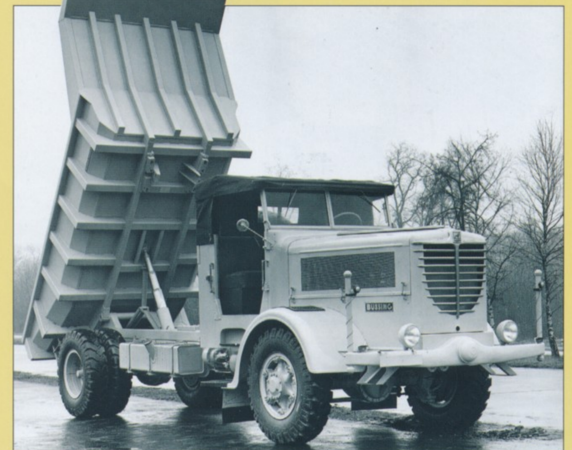
Martialische Optik: 8000 S Allrad mit faltverdeck und Meiller-Mulde für den Export in ein tropisches Land.
