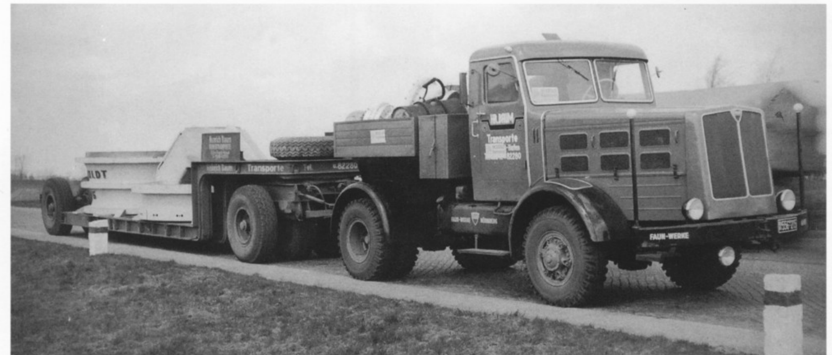
Mit dem Faun L 8/38 ZA stand bei Baum erstmals ein reinrassiges Schwertransportgerät zur Verfügung. ▼
