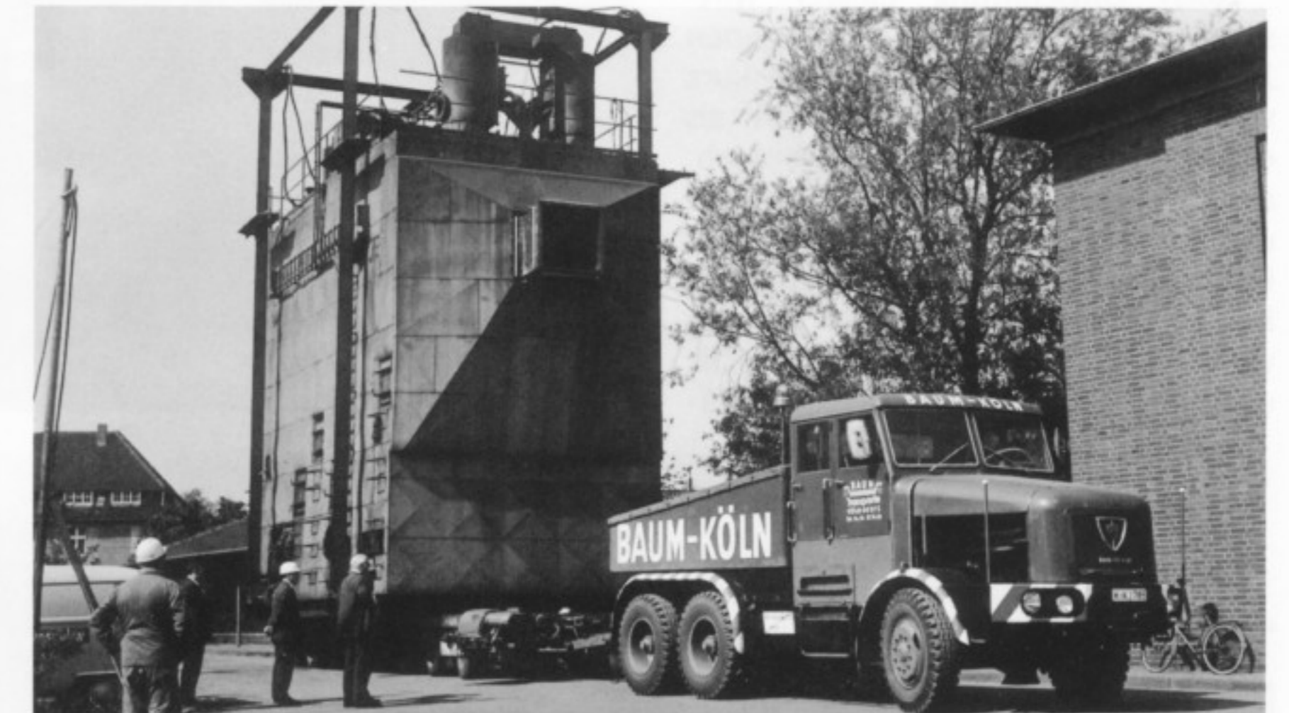
Der Faun L 1212/45 ZA machte 100 Tonnen Anhängelast möglich.
